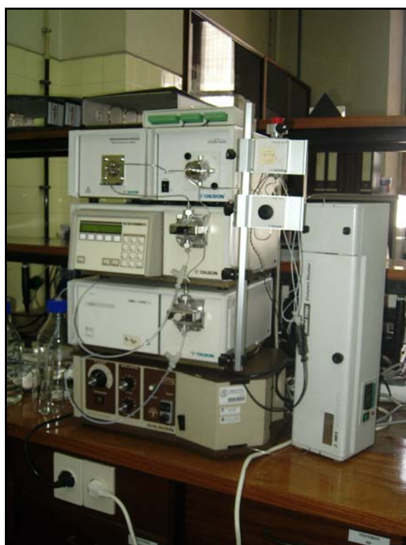
Figura 25. Sistema de HPLC-UV usado na separação e identificação de ácidos orgânicos.
