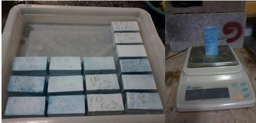
Fig. 47 - Imersão total e pesagem dos provetes de gesso.
