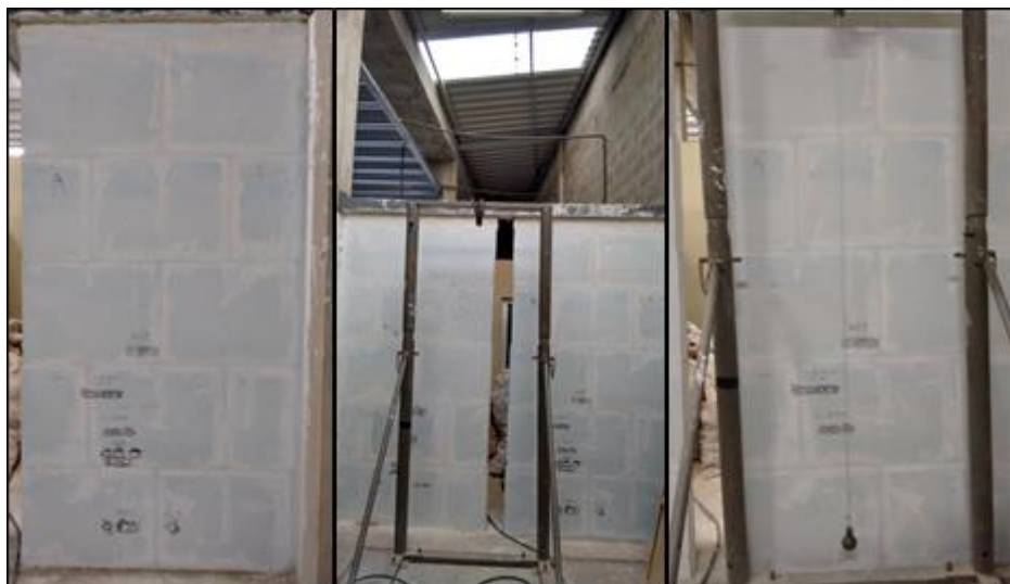
Fig. 31 - Paredes para ensaio de impacto de gesso hidro.
