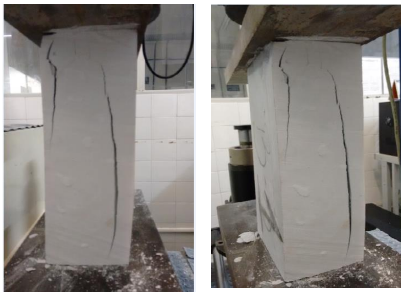
Fig. 87 – Resultado visual do ensaio de determinação de resistência à compressão.
