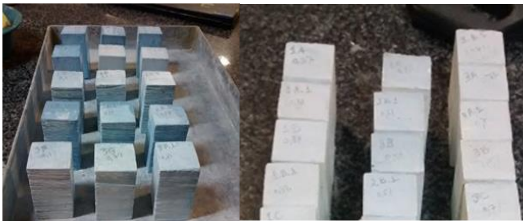
Fig. 49 - Amostras dos provetes para ensaio de saturação ( W_{sat} ).
