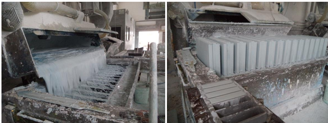
Fig. 29 - Dosagem mecânica e confecção dos blocos hidro na linha de produção da fábrica.
