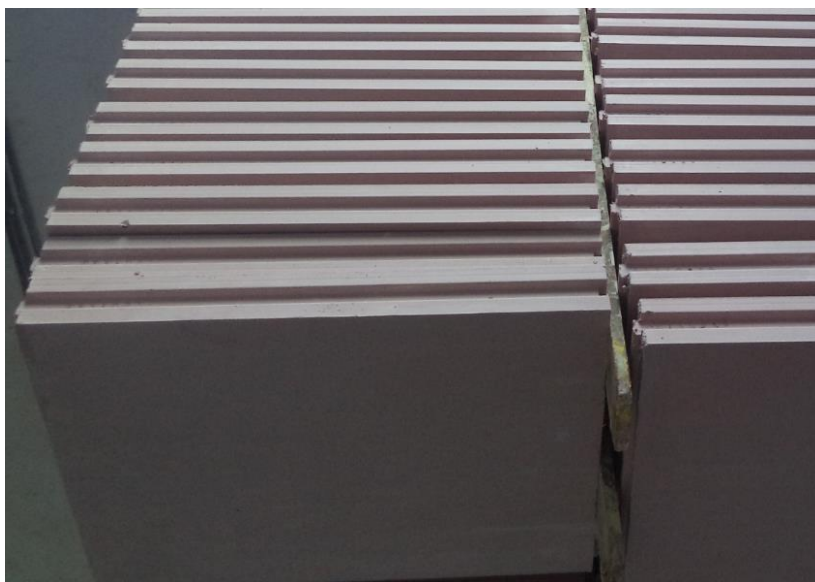
Fig. 9 - Bloco de gesso reforçado com fibra de vidro e hidrofugado.
