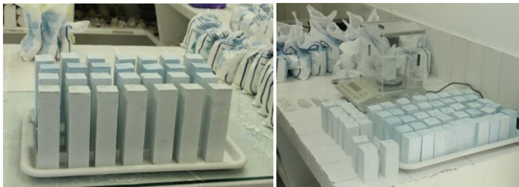
Fig. 43 - Provetes para ensaios com dimensões 40x40x160 mm e serrados com dimensões 40x40x80 mm.
