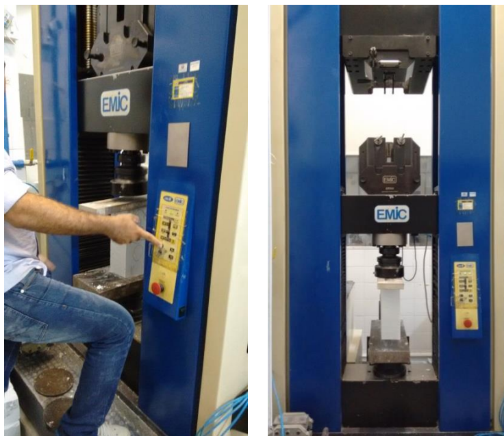
Fig. 62 - Prensa EMIC para 600KN servo-controlada.
