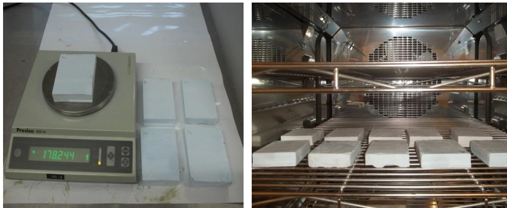
Fig. 46 - Pesagem e condicionamento de provetes para determinação de W_{80} .
