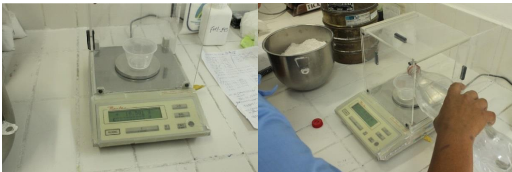
Fig. 42 - Recipiente e balança para dosagem do produto hidrofugante
