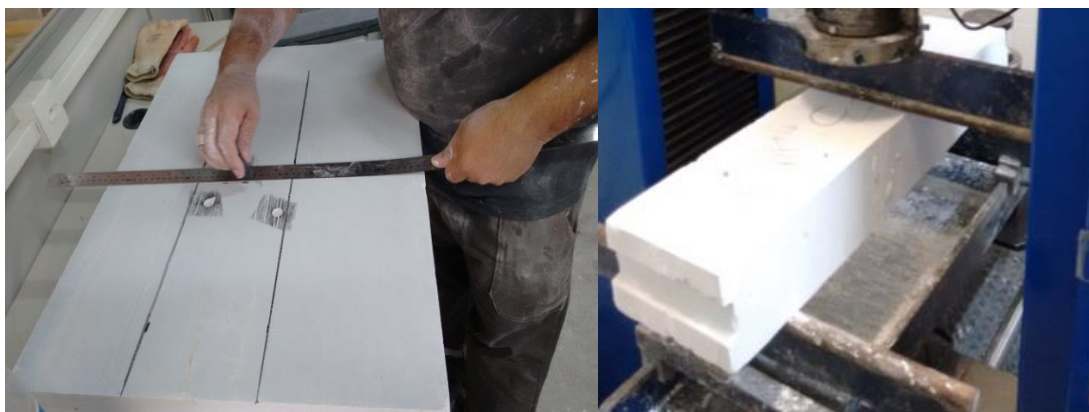
Fig. 61 - Preparação e aplicação do provete no ensaio de resistência à flexão.
