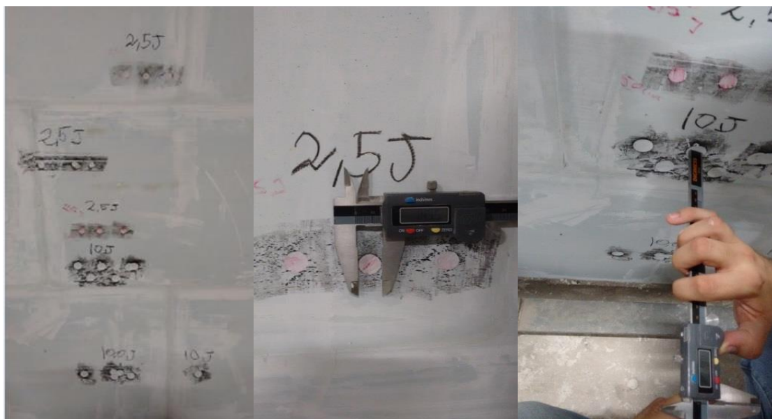
Fig. 95 – Identificação das mossa do ensaio de corpo duro.
