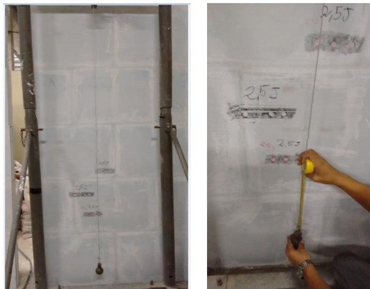
Fig. 76 - Elementos construtivos avaliados (corpo duro).
