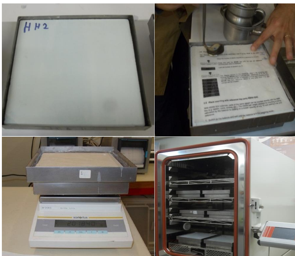
Fig. 53 - Etapas do ensaio de permeabilidade ao vapor.
