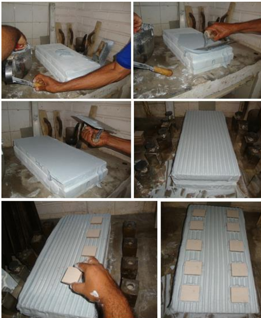
Fig. 70 - Preparação das amostras para o ensaio de aderência.
