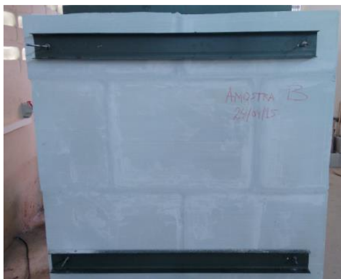
Fig. 68 - Área de avaliação do ensaio de estanquidade
