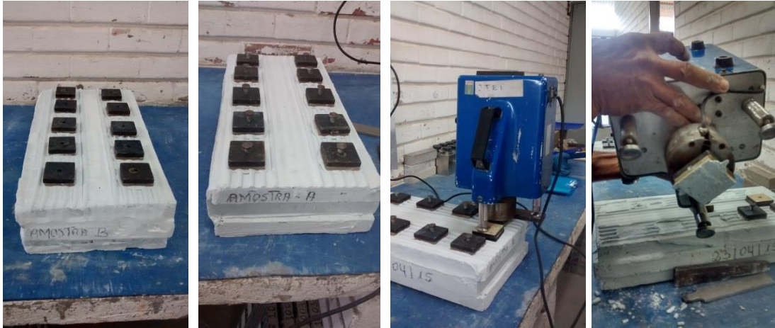
Fig. 71 – Realização do ensaio de arrancamento.
