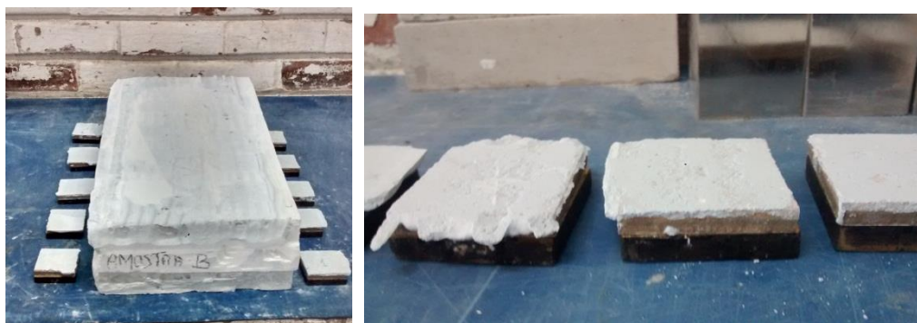
Fig. 94 - Tipos de ruptura obtidos no ensaio de determinação da resistência de aderência à tração de revestimento.
