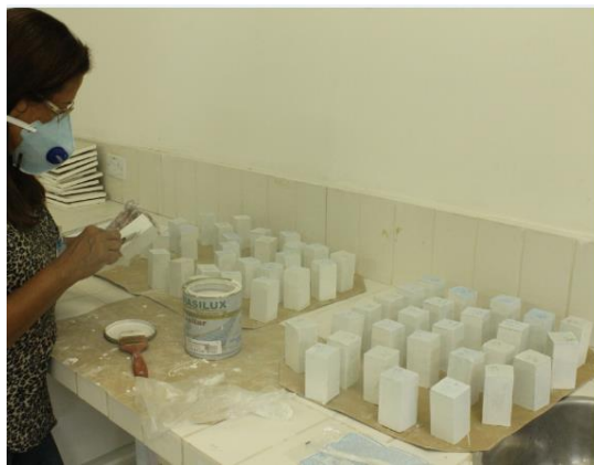
Fig. 37 - Impermeabilização das faces dos provetes.
