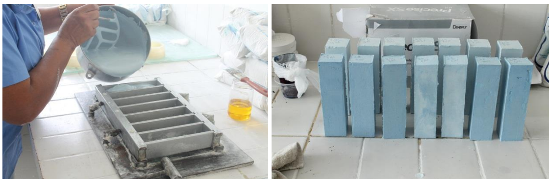
Fig. 27 - Molde metálico para fabricação de provetes e provetes de gesso para blocos hidro.
