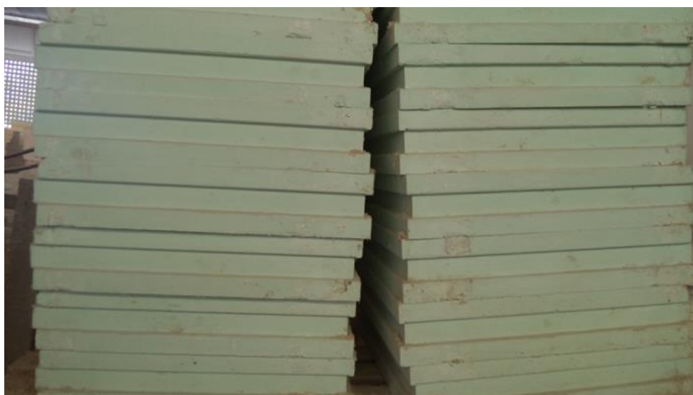
Fig. 8 - Bloco de Gesso com reforço de fibra de vidro.
