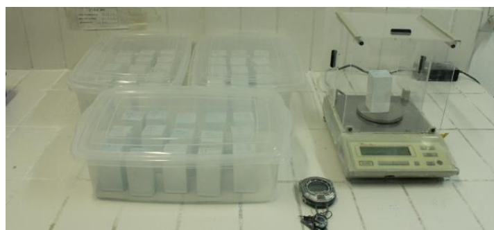
Fig. 38 - Imersão e pesagem dos provetes no ensaio de capilaridade.
