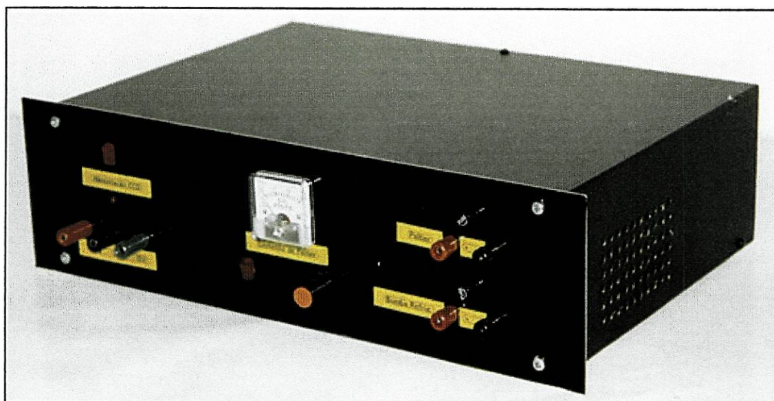
Figura 4.15 - Fonte de alimentação, vista geral.
