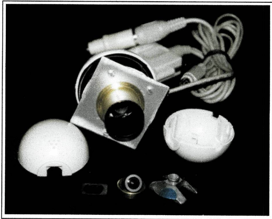
Figura 4.60 – Aspecto final da câmara adaptada e peças originais retiradas.
