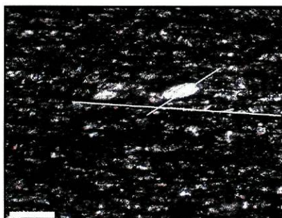
FIGURA 2 – Pormenor da amostra P1. O plano basal dos filossilicatos define uma estrutura planar posterior à foliação (N+, escala: 0,1mm)
