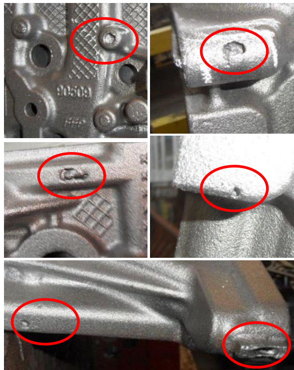
Figura 5 - Bolhas e respetiva localização na peça.
