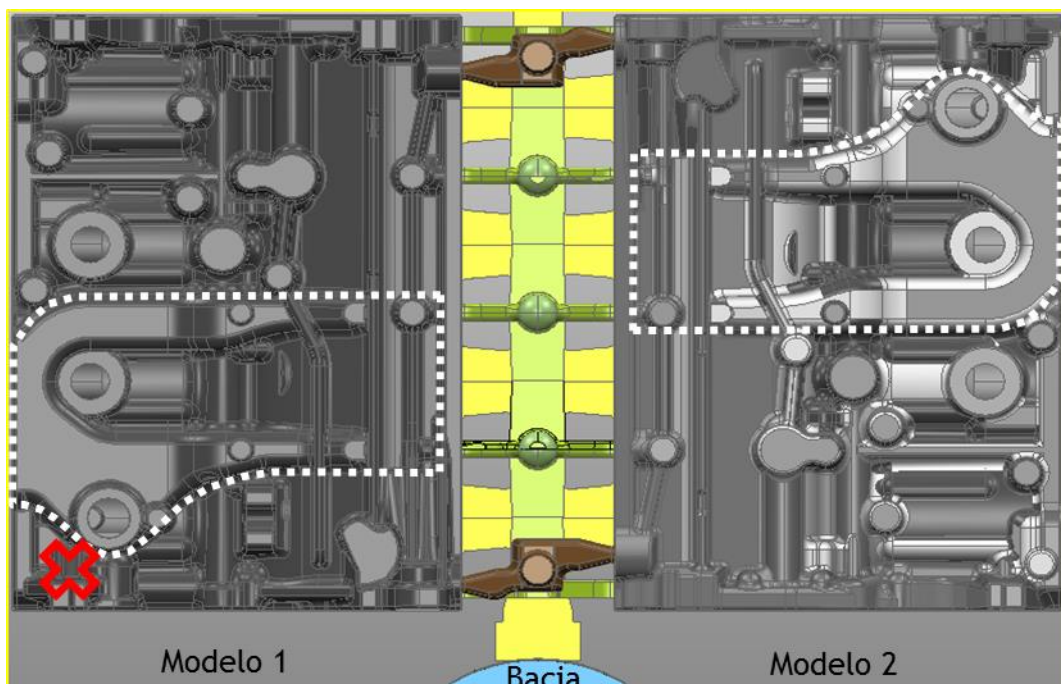
Figura 33 - Localização do defeito (bolha) no modelo 1 relativo à condição B através de um X de cor vermelha. Imagem obtida através do software PowerShape.
