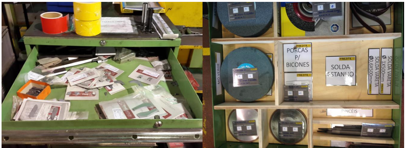
Figura 35 – Exemplo de armário de consumíveis da soldadura antes e depois do projeto
