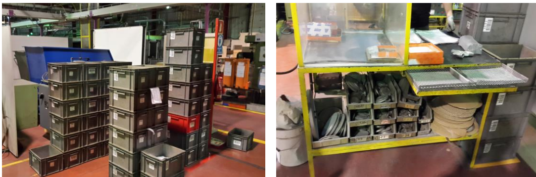
Figura 28 – Elevado stock em curso na soldadura (esquerda) e ausência de gestão visual de consumíveis (direita)
