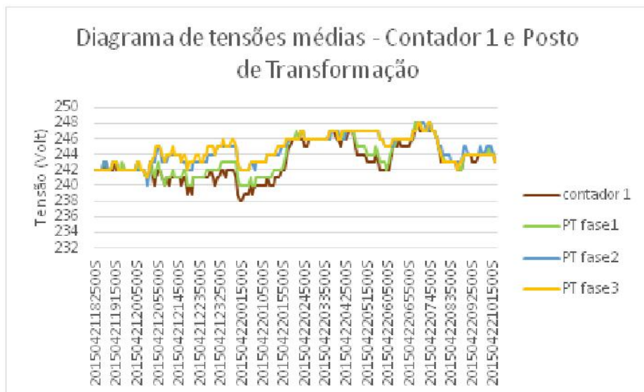
Figura 3.2: Dados da tensão média do contador 1 e das três fases do contador no Posto de Transformação
