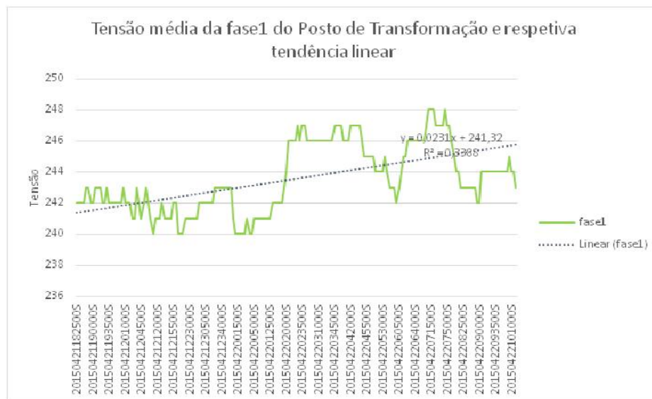
Figura 4.72: Tendência linear da série de tensão média da fase 1 do Posto de Transformação
