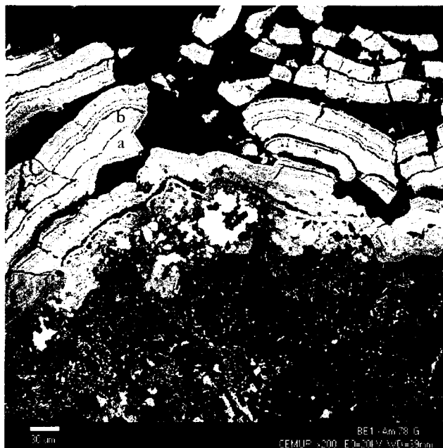
Figura 59 - Alteração supergénica arseneto Ni, com a deposição de um sulfato de NiAs (?) com uma textura colofórmica, em que é visível um zonamento químico. (MEV-IR).
