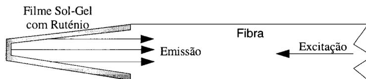
Figura 5.52 – Esquema do concentrador.
