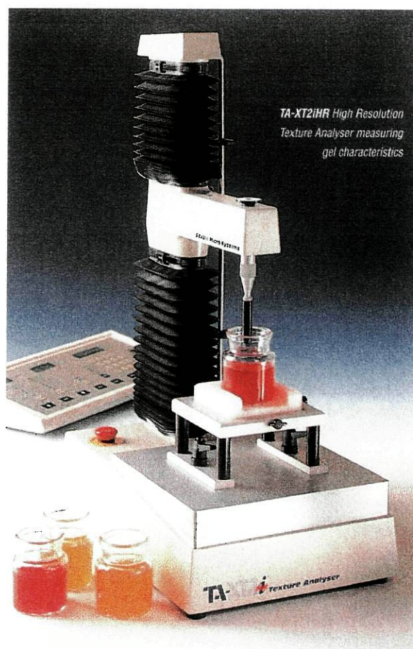
Figura 52 – Representação do texturómetro TA-XT2i utilizado nos ensaios de textura.
