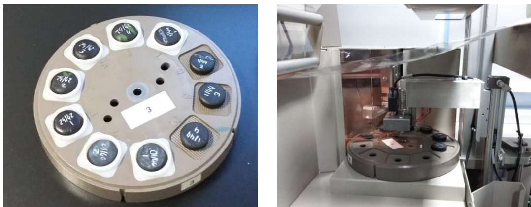
Figura 12 - Tabuleiro das amostras (à esquerda) e sistema de deteção das amostras no RPA (à direita)
