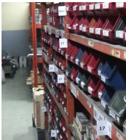
Figura 37: Pormenor dos "T" colocados nas estantes do supermercado
