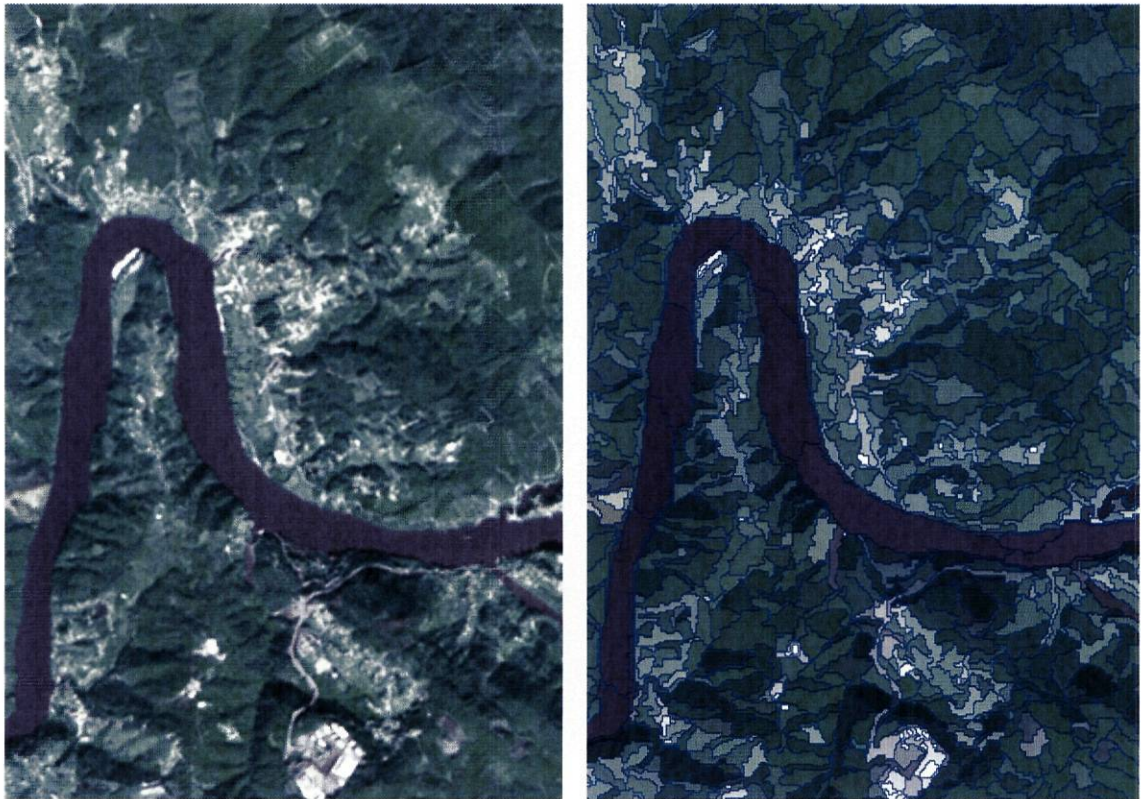
Figura 3.3: Uma parte da imagem original (composição RGB de 3 bandas do ASTER, à esquerda) e à direita a segmentação dessa imagem.
