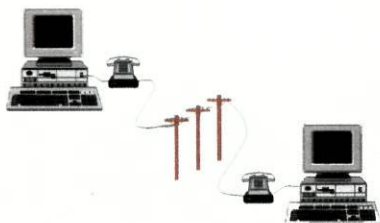
comunicação entre computadores através de modems e linhas telefônicas (Net Magazine nº29: 74)
