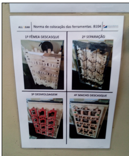
Figura 17 - Norma de colocação das ferramentas junto à máquina
