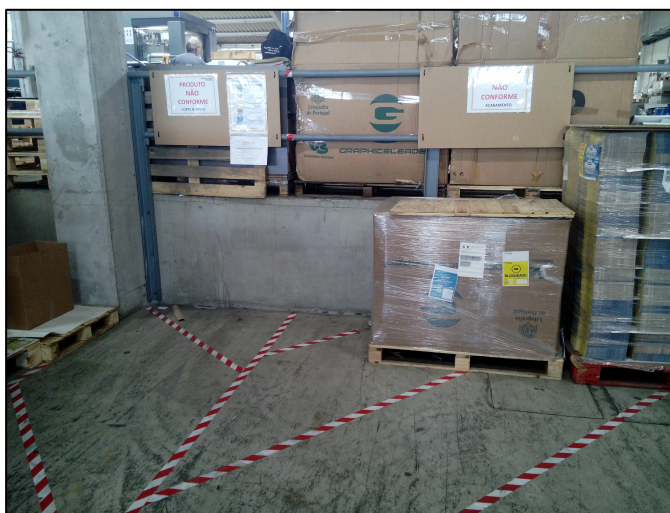
Figura 19 - Zona de produto não conforme na secção do Corte e Vinco
