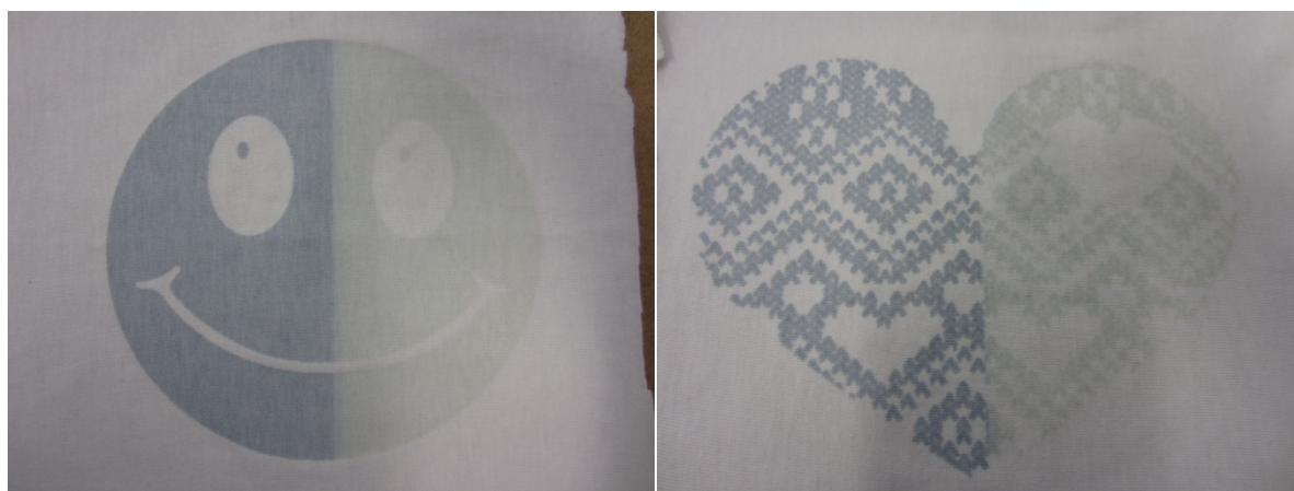
Figura 7.6 Fotografias dos motivos estampados (☺ e ♥) numa malha de algodão após 17 h de irradiação com luz UV (parte azul).
