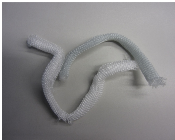
Figura 7.12 Malhas têxteis: 100% PP (malha branca) e 60% PPNPS (malha azulada).
