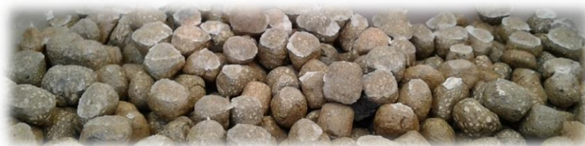
Figura 24 - Cristais de sal à superfície da argila expandida, numa zona onde não houve contato direto com a água residual salina simulada.
