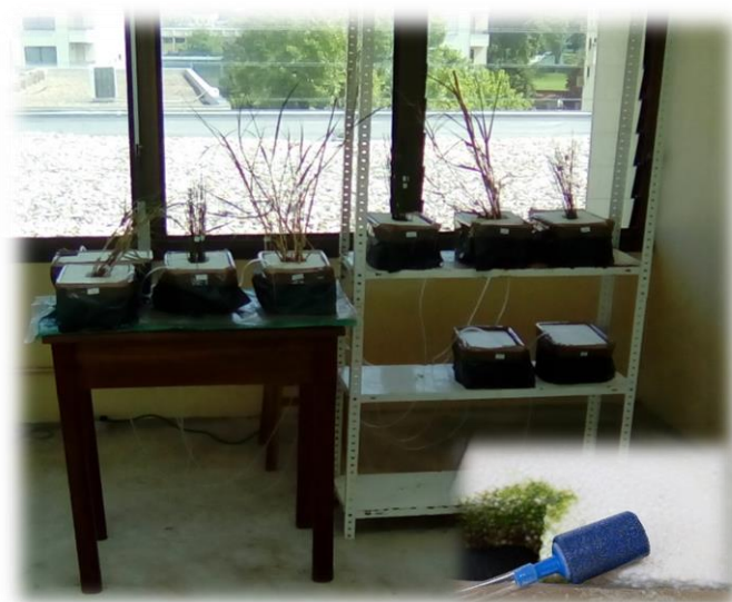
Figura 18 - Microcosmos em hidroponia com as plantas Spartina maritima e Juncus maritimus e ainda três microcosmos de controlo, colocados de forma aleatória. No canto inferior direito, pormenor da pedra difusora de ar utilizada.
