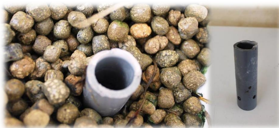
Figura 17 - Tubo perfurado colocado nos microcosmos com argila. Os orifícios mais pequenos que as esferas de argila permitem uma sifonagem eficaz.
