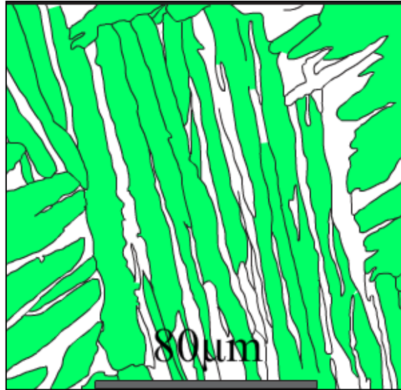
Figura 4 - Latão \alpha - \beta com composição 60-40 [8].
