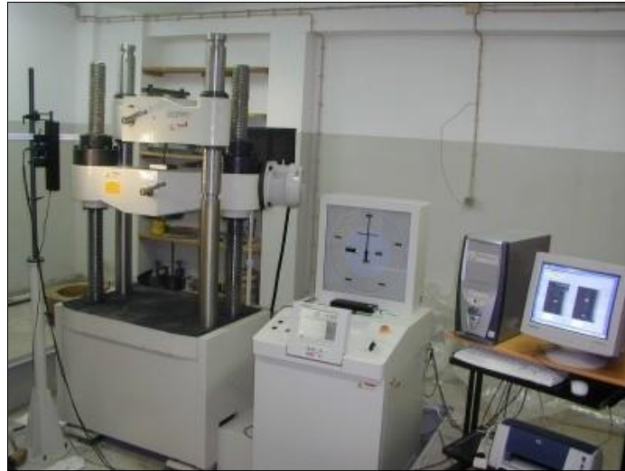
Figura 16 - Máquina de tração Shimadzu UH 1000kNI [38].
