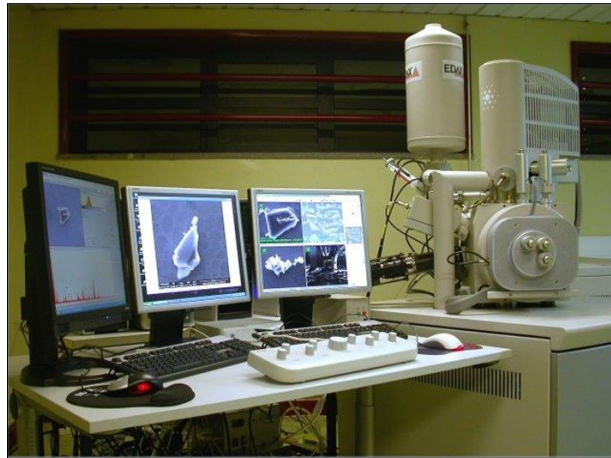
Figura 17 - - Equipamento de SEM e EDS - FEI Quanta 400 FEG ESEM/EDAX Genesis X4M [39].
