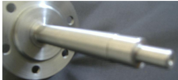
Figura 52 – Fotografia do veio do resolver fabricado e roscado no veio de transmissão
