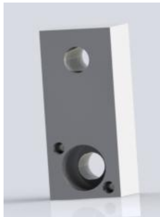
Figura 60 – Modelação 3D do elemento de ligação entre apoio da caixa e caixa redutora
