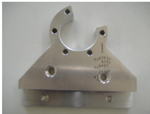
Figura 54 – Fotografia do apoio principal fabricado
