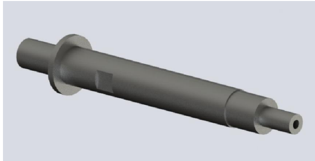
Figura 51 – Modelação 3D do veio do resolver
