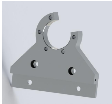
Figura 53 – Modelação 3D do apoio principal do motor
