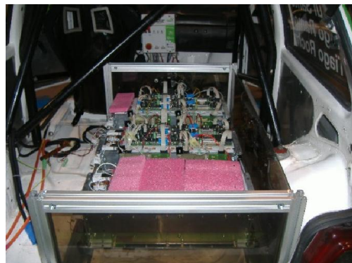
Figura 70 – Montagem da caixa e packs no veículo
