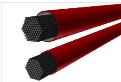
Fig. 2. 14 – Tirantes com cordões paralelos com forma hexagonal (Ltd).
