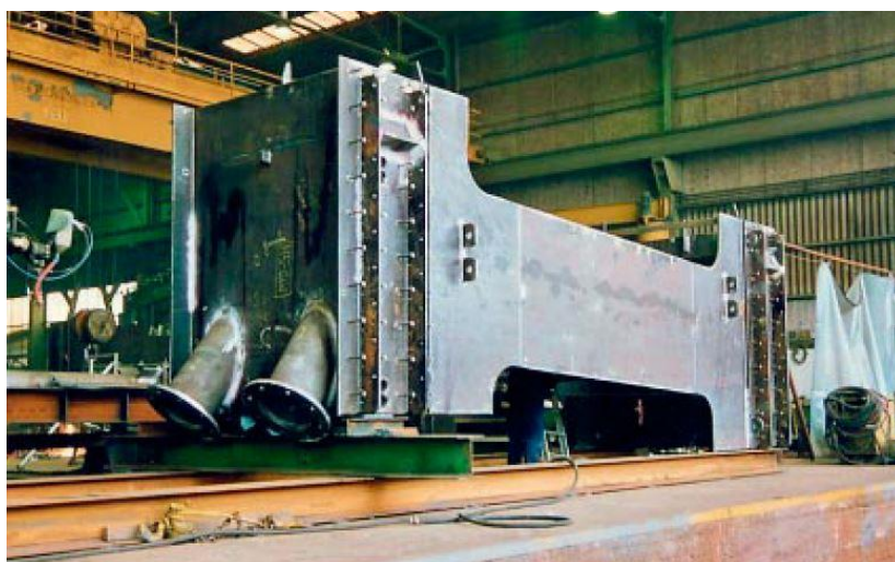
Fig. 2. 17 - Estrutura metálica de ancoragem dos tirantes (Svensson 2013).
