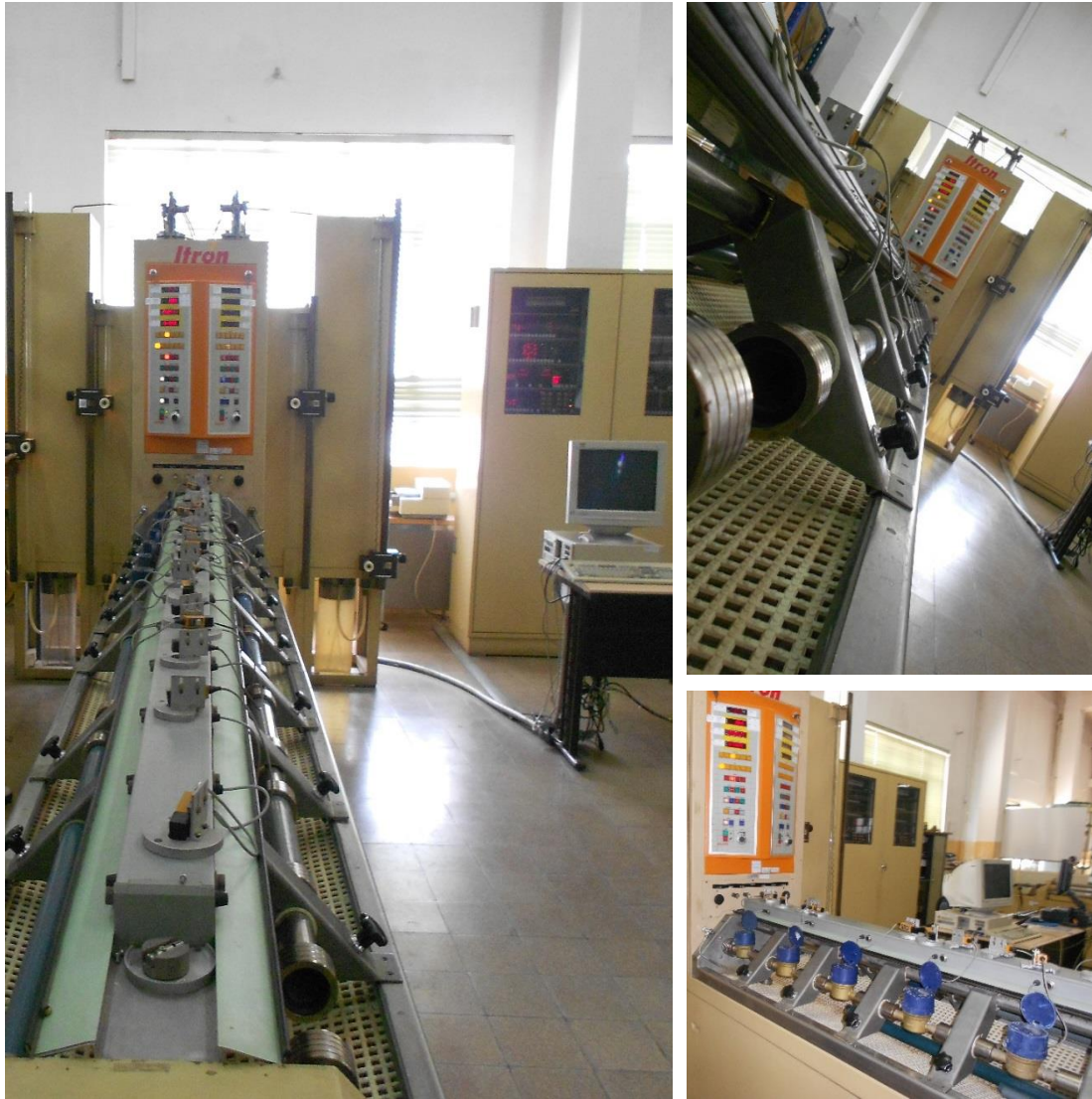
Figura 48 – Banca onde se realizou o estudo laboratorial de medição do erro nos contadores.
