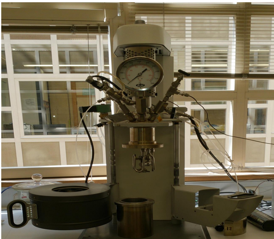
Figura 11 - Reator da marca Parr utilizado nas reações de esterificação de resíduos.
