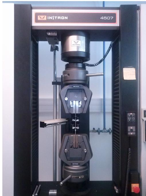
Figura 3.1: Máquina de ensaios de tração uniaxial INSTRON Modelo 4507 presente no laboratório de ensaios mecânicos do INEGI.
