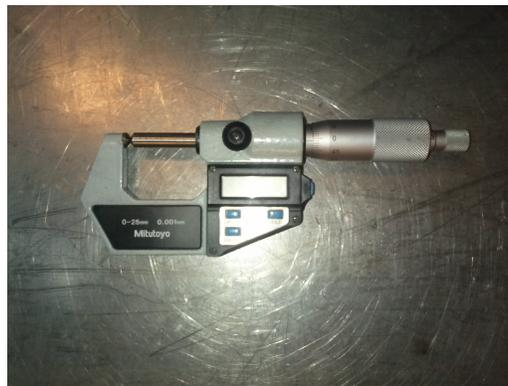
Figura 3.8: Micrómetro de pontas esféricas da Mitutoyo presente no laboratório de ensaios mecânicos do INEGI.
