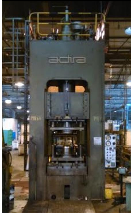
Figura 3.7: Prensa utilizada para embutir as coquilhas das garrafas de 20L presente na AMTROL-ALFA.
