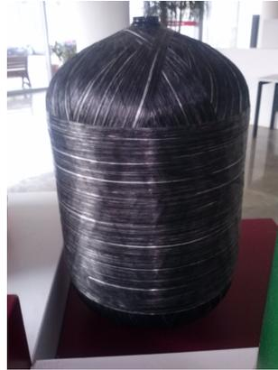
Figura 1.3: Garrafa CoMet após o enrolamento filamentar.
