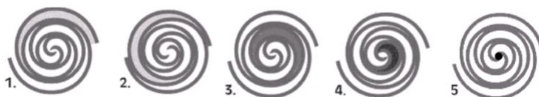
Figura J.11 - Processo de Compressão de um compressor Scroll.
