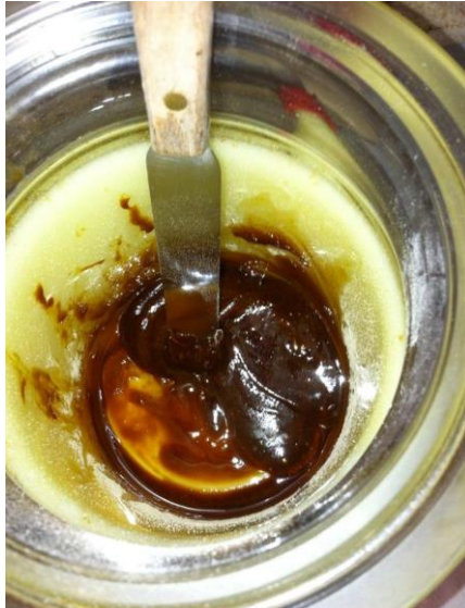
Figura 12. Goma-Laca após fusão completa.
