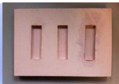
Figura 10. Molde de silicone
