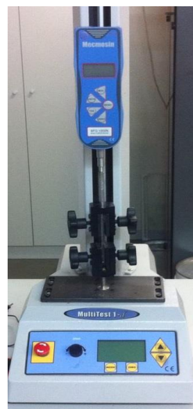
Figura 17. Dinamómetro montado na bancada de ensaios
