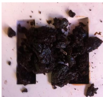
Figura 21. Mistura de borracha natural com goma-laca após ultrapassado limite de temperatura.
