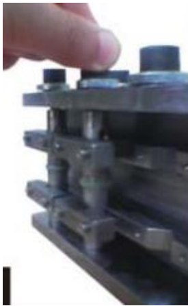
Figura 116 – Molde para fabricar as juntas adesivas
