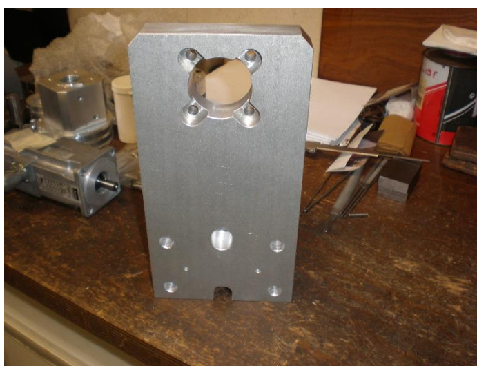
Figura 48 - Fotografia do apoio redutor
