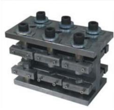
Figura 116 – Molde para fabricar as juntas adesivas
