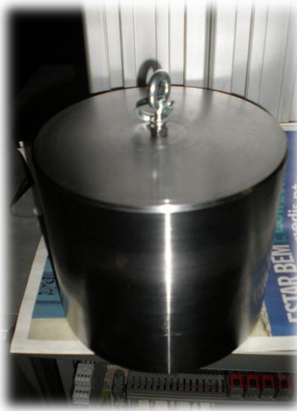
Figura 55 – Fotografia do contrapeso de equilíbrio das partes móveis
