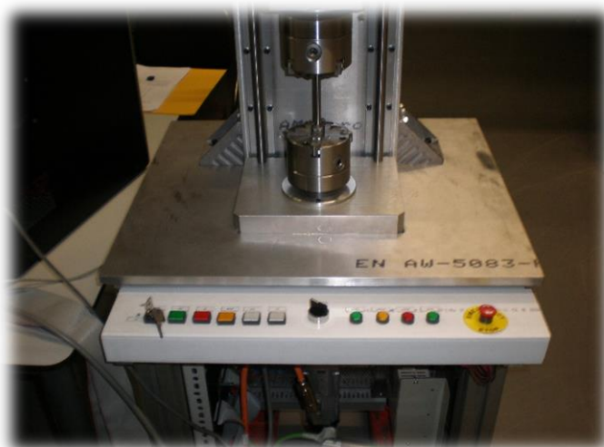
Figura 62 – Fotografia das duas buchas de fixação
