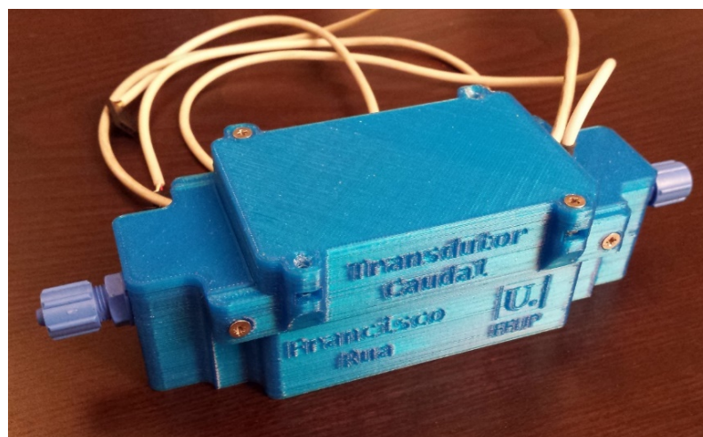
Figura 3.21 – Protótipo do transdutor de caudal desenvolvido
