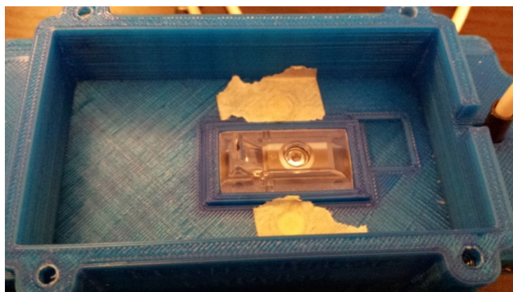
Figura 3.31 – Localização da lente de focagem no protótipo final
