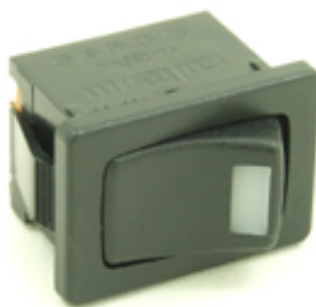
Figura 4.17 – Switch mecânico utilizado para seleção do estado inicial
