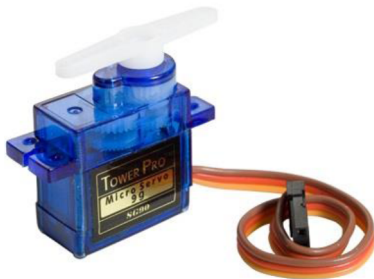
Figura 2.7 – Motor DC utilizado para atuação da gaveta[1]
