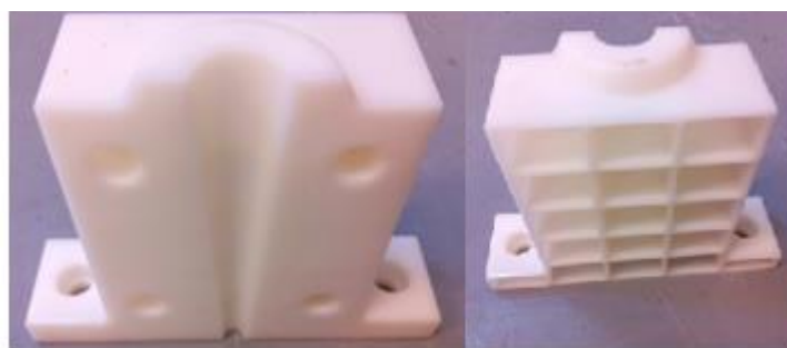
Figura 83 - Protótipo realizado em estereolitografia da bacia cônica
