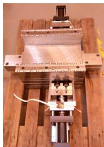
Figura 53 – Layout selecionado para a coquilha da peça 82000 (Duarte 2014)
