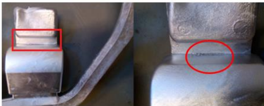
Figura 142 - Testes de vazamento em FCG (STA). À esquerda a alteração da zona de pescoço e à direita a presença de rechupes na zona de ligação
