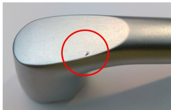
Figura 105 - Defeito provocado pela existência de turbulência e óxidos durante o vazamento
