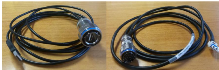
Fig. 4.12 – Pormenorização dos cabos conectores, USB de transmissão de dados (à esquerda), de transmissão de energia (à direita)
