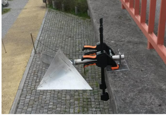
Fig. 4.22 – Cone refletor e respetivo apoio de ligação utilizados nos casos de estudo
