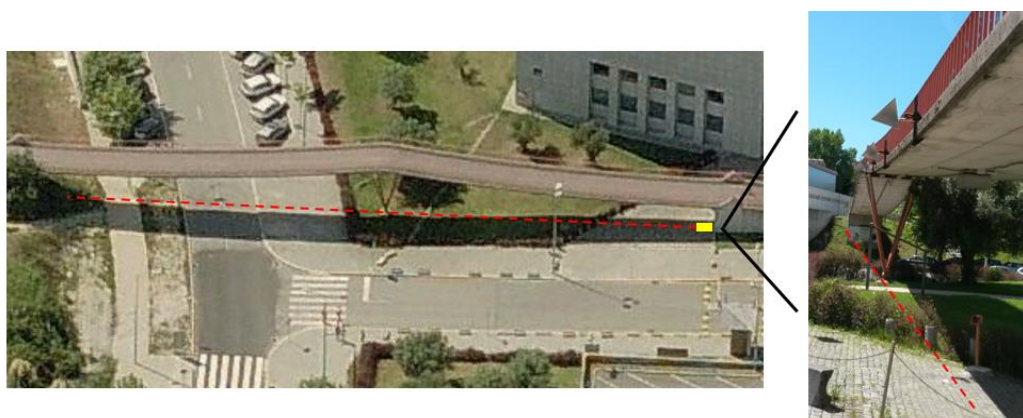
Fig. 6.48 - Posicionamento do radar e direção de monitorização, vista panorâmica (à esquerda) e vista frontal (à direita)
