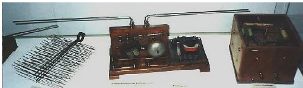
Fig. 3.2 – Telemobiloscópio e componentes, antena (à esquerda), recetor (ao meio), transmissor (à direita) [54]
