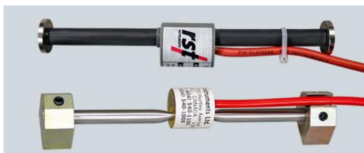
Fig. 2.23 – Extensómetros de corda vibrante, de embeber no betão (em cima), de colocar á superfície do betão (em baixo) [34]
