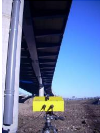
Fig. 4.20 – Posicionamento típico do radar, pontes, adaptado de [76]
