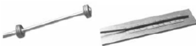
Fig. 2.24 – Sensores de fibra ótica, de embeber (à esquerda), de acoplar à estrutura (à direita) [6]
