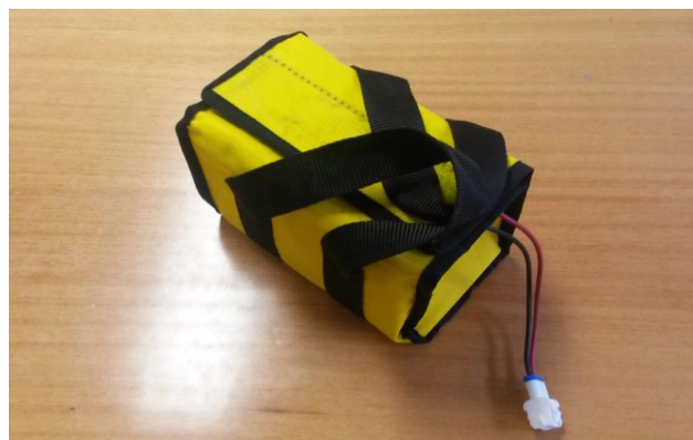
Fig. 4.13 – Unidade de fonte de alimentação, 12V
