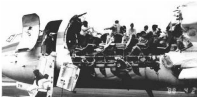
Fig. 2.13 - Acidente de aviação, voo 243 Aloha Airlines, 1988, falta de controlo da corrosão pela equipa de manutenção [4]
