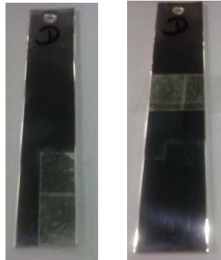
Figura 21 - Teste de aderência em alumínio prateado.
