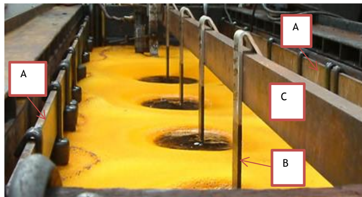
Figura 3.6- Tanque e equipamento utilizado para realizar Cromo Duro: A-Ânodos de Chumbo; B-Ganchos; C-Barramento de Cobre.
