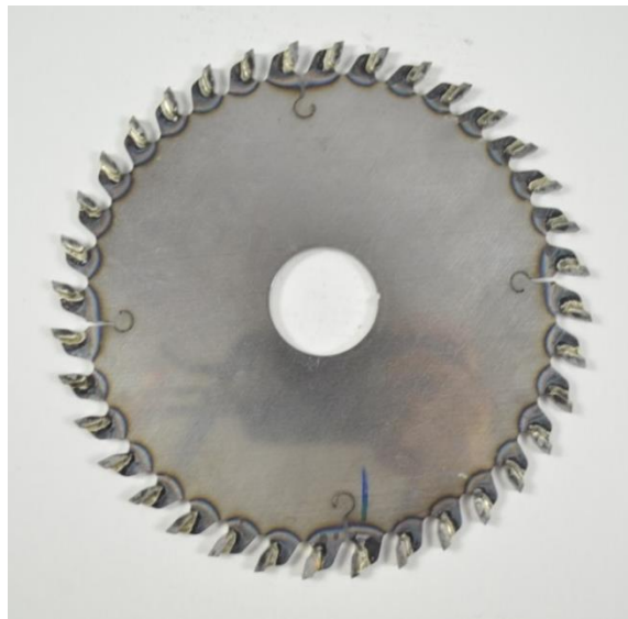
Figura 6.23 -Serra circular no estado em que é comercializada, sem revestimento superficial (Serra FREZITE Original).
