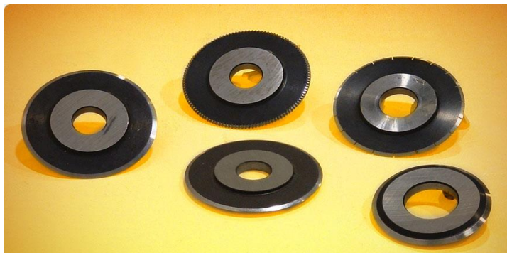
Figura 3.10 -Exemplos de peças que sofreram oxidação negra [42].
