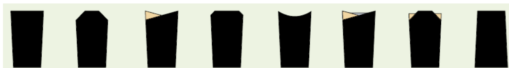
Figura 2.5-Diferentes geometrias do gume cortante dos dentes [10].
