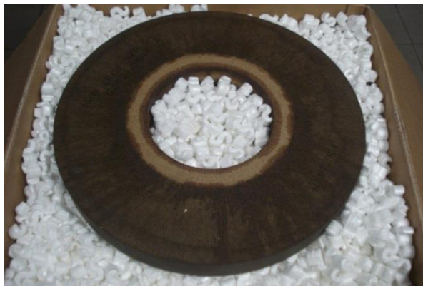
Figura 6.42-Mó de cortiça utilizada para o polimento da serra FREZITE Nova.
