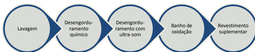
Figura 3.11 -Sequência industrial do processo de oxidação negra.
