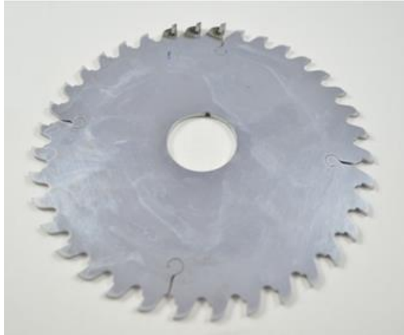
Figura 6.24 -Serra circular com revestimento Cromo Duro e posteriormente as pastilhas brasadas (Serra FREZITE Cromo1).
