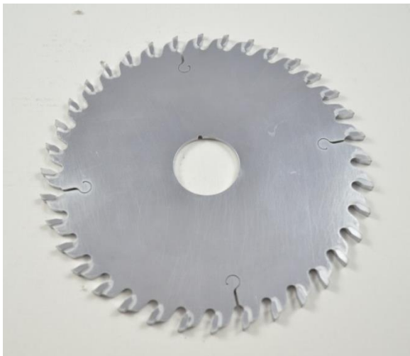
Figura 6.26 -Serra circular FREZITE com pastilhas brasadas e posteriormente revestimento Cromo Duro (Serra FREZITE Cromo 2).
