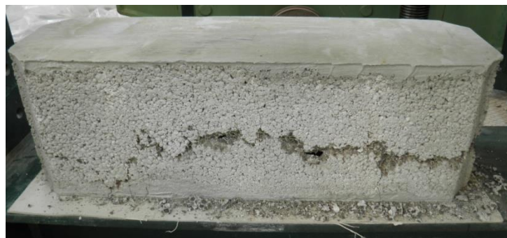
Fig. 3.8 - Provete retificado após o ensaio de resistência à compressão
