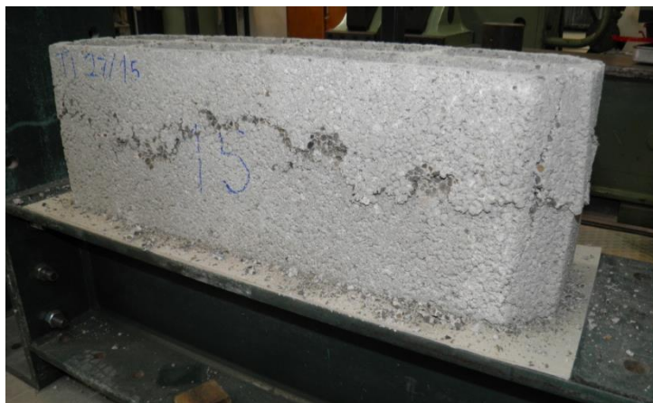
Fig. 3.10 - Provete com superfície preparada por esmerilagem após o ensaio de resistência à compressão
