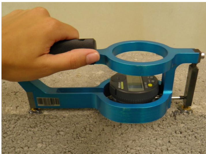
Fig. 3.21 - Defletómetro utilizado na medição das deformações ocorridas durante a retração dos blocos
