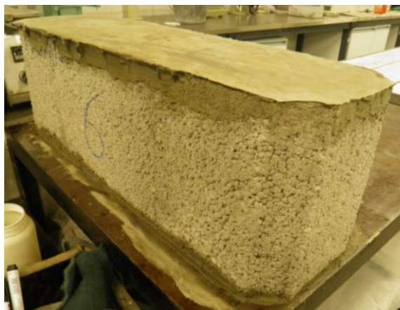
Fig. 3.6 - Preparação da superfície dos blocos por nivelamento com argamassa
