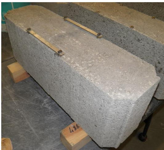
Fig. 3.19 - Colagem das fixações usadas na medição com recurso à barra de referência (base de medida)
