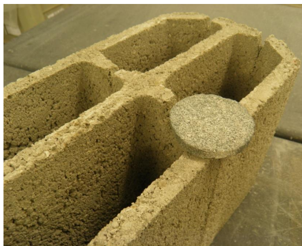
Fig. 3.5 - Preparação da superfície dos blocos por esmerilagem
