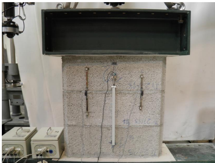
Fig. 3.13 - Amostra número 1 antes da realização do ensaio com os transdutores já posicionados
