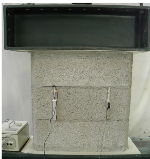
Fig. 3.15 - Amostra número 2 antes da realização do ensaio com os transdutores já posicionados
