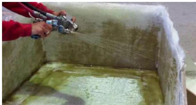
Figura 4.34 Moldação das peles exteriores com projeção de resina.
