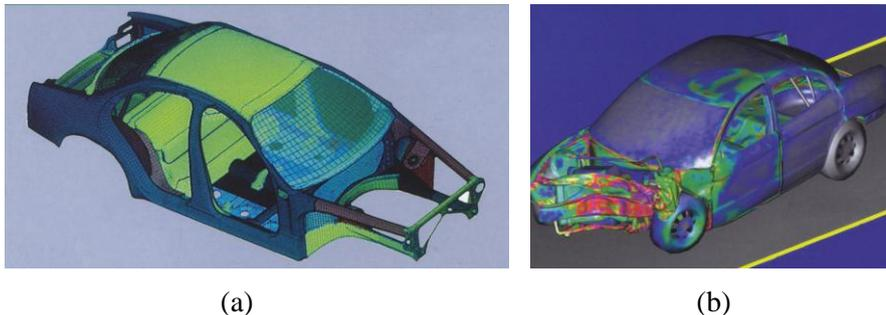
Figura 2.45 Modelação em computador da estrutura ULSAB (a) e simulação do comportamento em caso de colisão, através de elementos finitos (b).
