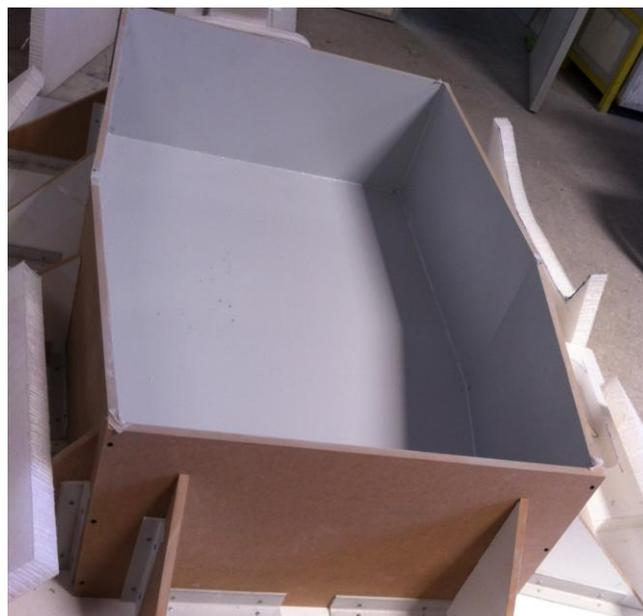
Figura 4.29 Molde com revestimento interior de *gel coat*.
