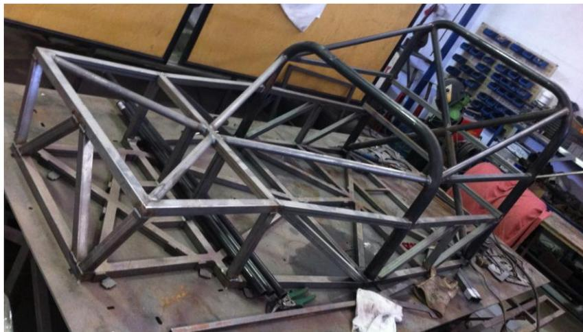
Figura 3.12 Fotografia do fabrico da estrutura durante o processo de soldadura sobre o *gabri*.
