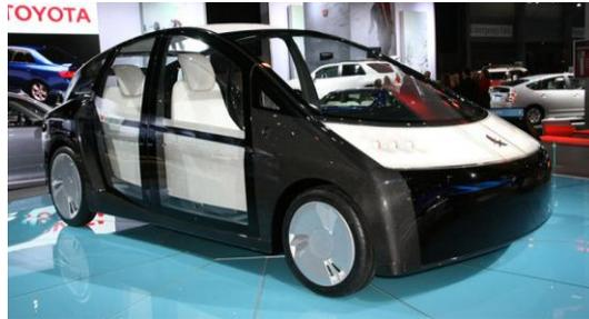
Figura 2.95 Protótipo 1/X da Toyota®, construído com aplicação de plásticos derivados de algas marinhas [86].
