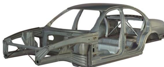
Figura 2.46 Estrutura construída na Fase 2 do projeto ULSAB [46].
