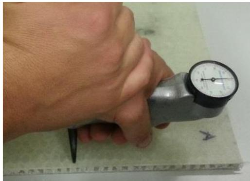
Figura 4.4 Durómetro de Barcol para medição da dureza superficial das peles das estruturas fabricadas.
