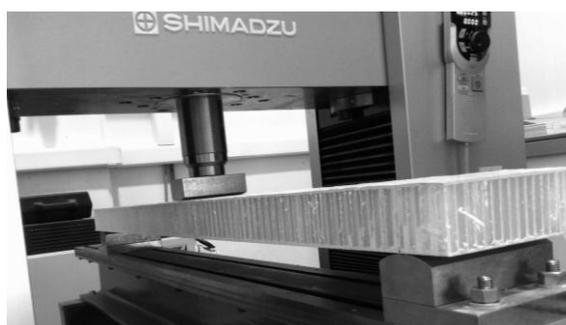
Figura 4.12 Ensaio de flexão em 3 pontos a uma *sandwich* de PP/FV, de acordo com a norma ASTM C393-00.
