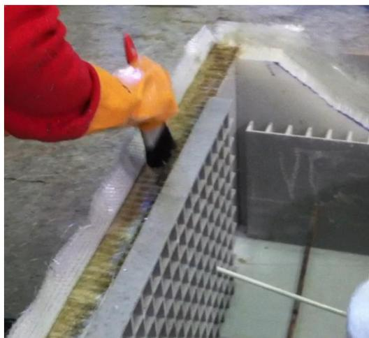
Figura 4.37 Moldação das peles dos tops dos painéis *sandwich*.
