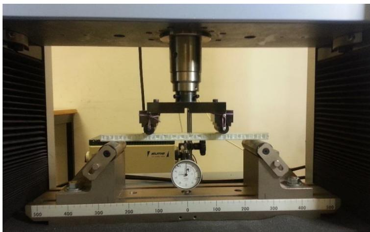
Figura 5.10 Posicionamento do provete P1.Fx4P.P1, para a realização do ensaio de flexão de 4 pontos.
