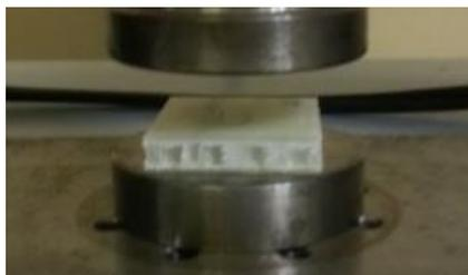
Figura 5.14 Estado final do provete P1.Comp.P5 após o ensaio de compressão.
