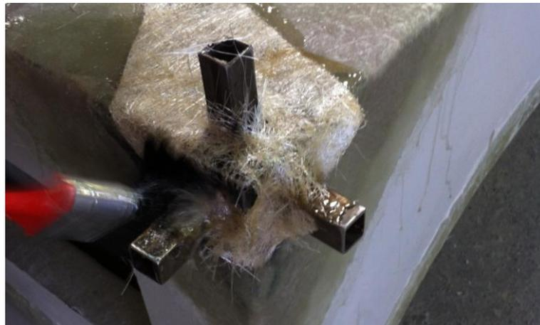
Figura 4.41 Inserção de um acessório mecânico para fixação da estrutura à mesa de ensaio.
