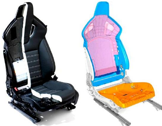
Figura 2.88 Compósitos GFRP utilizados no fabrico da estrutura dos bancos da frente do novo Opel<sup>®</sup> Insignia OPC desenvolvidos pela Opel<sup>®</sup> e pela Recaro<sup>®</sup> [82].
