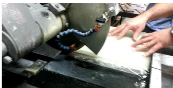
Figura 4.2 Corte de provetes a partir das placas *sandwich* fabricadas.
