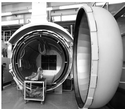
Figura 2.80 Autoclave de grandes dimensões para cura de componentes em FRP.
