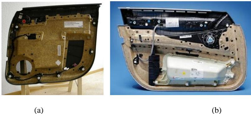
Figura 2.94 Paineis interior de revestimento de portas de automóveis em biocompósito de fibras naturais.
