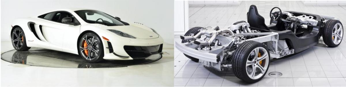
Figura 2.89 Estrutura monocoque integral em CFRP do super-desportivo McLaren<sup>®</sup> MP4-12C [83].
