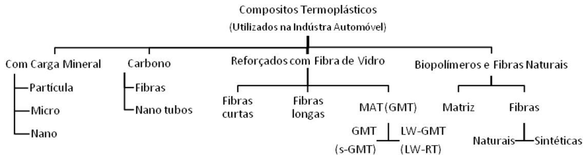
Figura 2.71 Família de materiais compósitos termoplásticos para a indústria automóvel [74].
