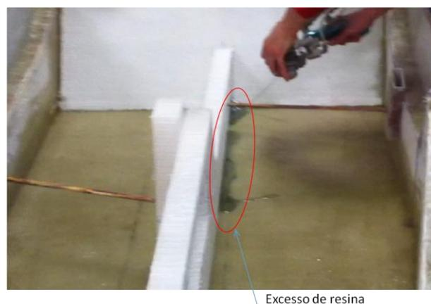
Figura 5.23 Excesso de resina na laminação da pele do lado interior da estrutura.
