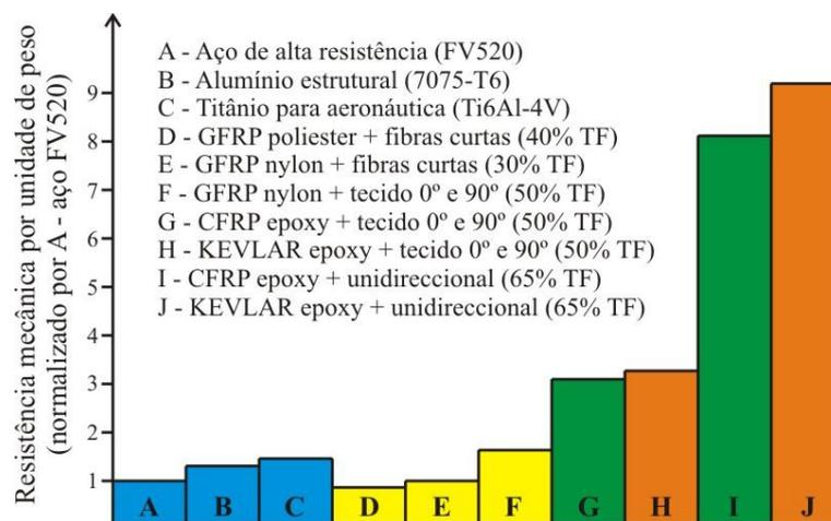
Figura 2.70 Comparação entre a resistência mecânica específica de alguns metais estruturais e FRP's.
