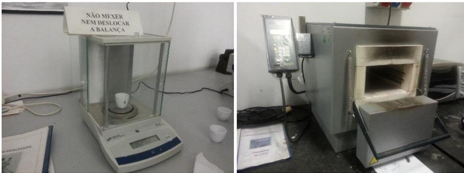
Figura 4.3 Balança para pesagem dos cadinhos (esquerda) e mufla para aquecimento dos cadinhos (direita).
