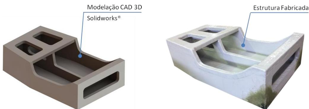
Figura 5.21 Estrutura E2.I3.2 fabricada em compósito.
