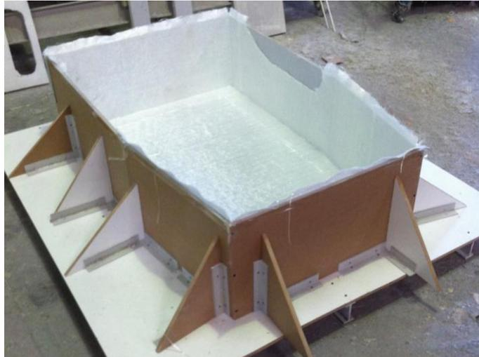
Figura 4.33 Colocação das fibras de reforço (manta e tecido) sobre o molde.
