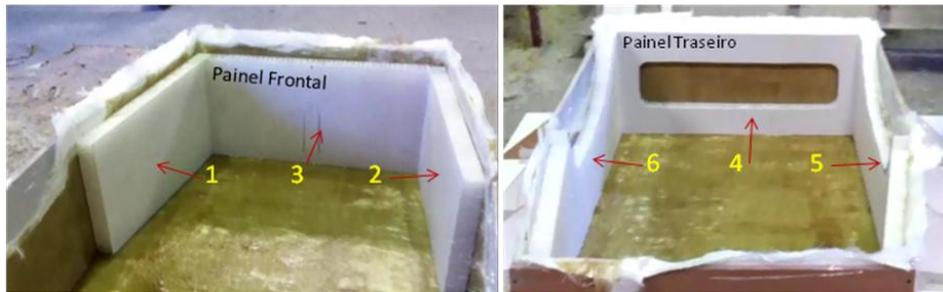
Figura 4.35 Sequência de colocação do núcleo dos painéis verticais no interior do molde.
