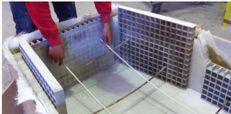
Figura 4.36 Pressão sobre as faces interiores do núcleo dos painéis no início da cura.
