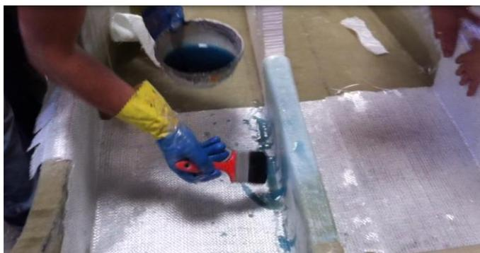
Figura 4.39 Moldação da segunda pele interior da estrutura.
