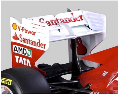
Figura 21 - Aplicação típica de uma asa invertida atrás do eixo traseiro (Ferrari F138). [8]
