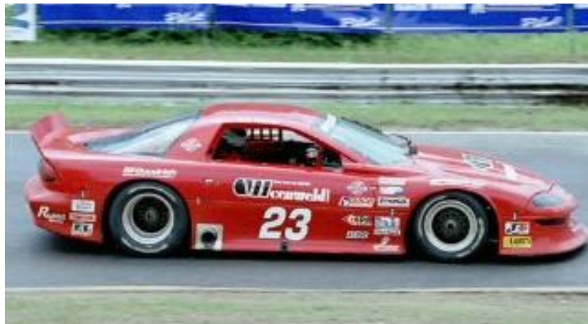
Figura 23 - Spoiler montado na traseira de um veículo de competição. [10]
