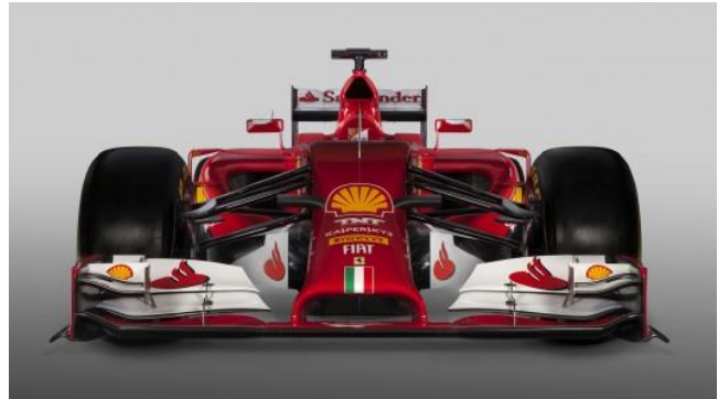
Figura 22 - Asa invertida montada na frente do Ferrari F14 T. [9]
