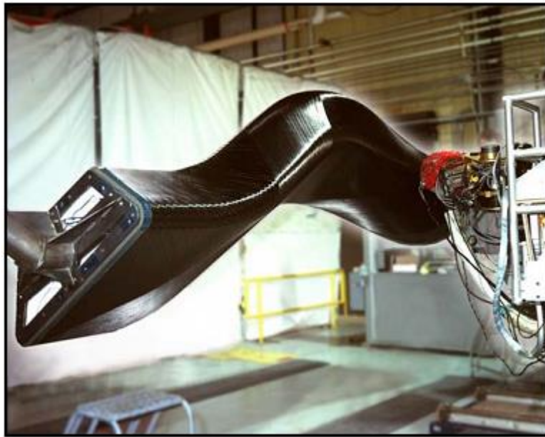
Figura 17 - Máquina de colocação de fibra (lado direito) a construir uma peça complexa e de alto desempenho para um avião (Beckwith, 2008)
