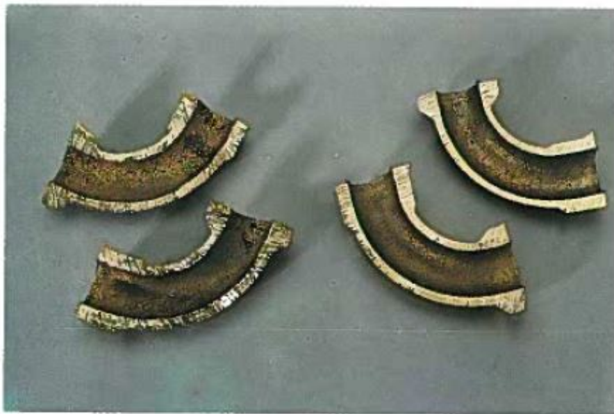
Figura 2.5: Esquerda: Peça com inclusões de areia devido à má compactação dos machos; Direita: Peça correta [Fernando Portela de Castro (1996)]
