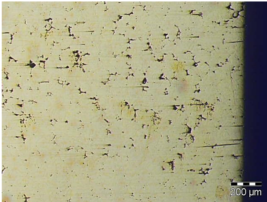
Figura A.31: Peça (E) - Com Fuga Pequena - 75×
