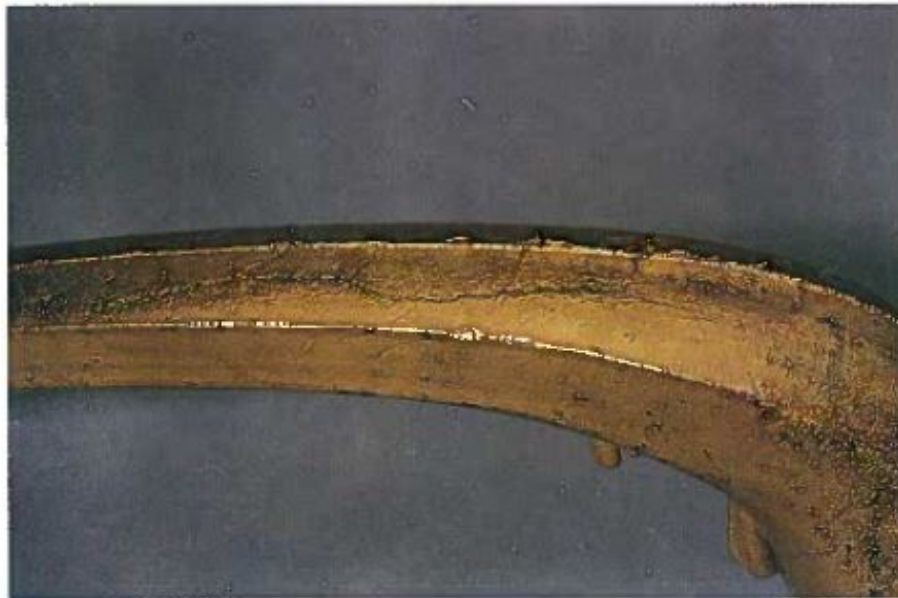
Figura 2.6: Peça com excesso de grafite [Fernando Portela de Castro (1996)]
