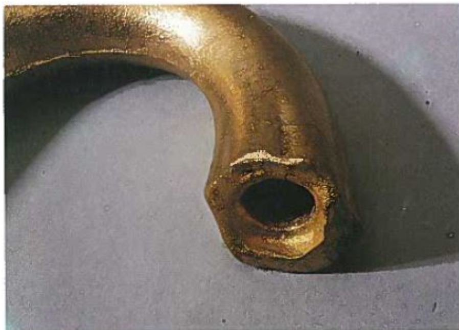
Figura 2.15: Peça com enchimento incompleto [Fernando Portela de Castro (1996)]
