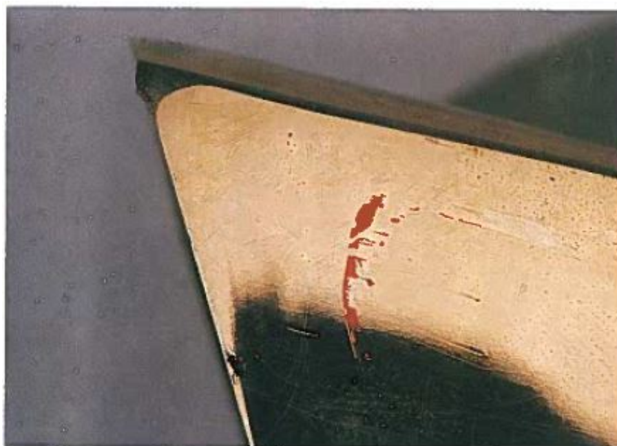
Figura 2.17: Peça com caudas de cometa [ Fernando Portela de Castro (1996) ]
