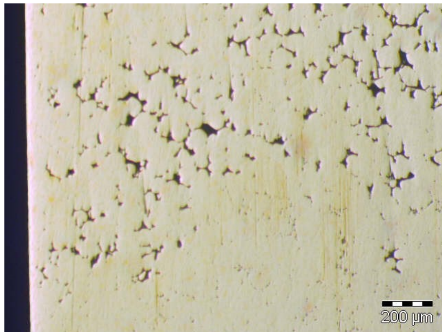
Figura A.22: Peça (D) - Com Fuga Pequena - 75×
