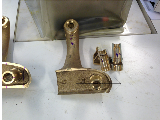
Figura 3.2: Sentido de Corte das Torneiras. Torneira fornecida pela CIFIAL e analisada no INEGI
