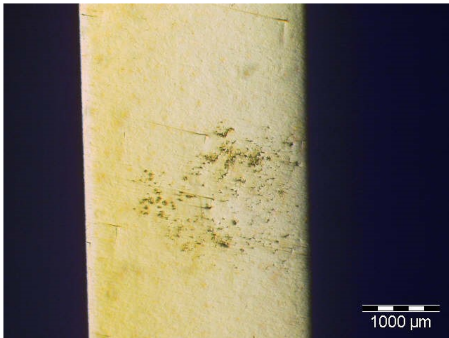
Figura A.18: Peça (C) ? - Com Fuga Grande - Dentro - 23×
