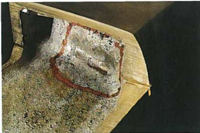
Figura 2.10: Peça com Rechupe [Fernando Portela de Castro (1996)]
