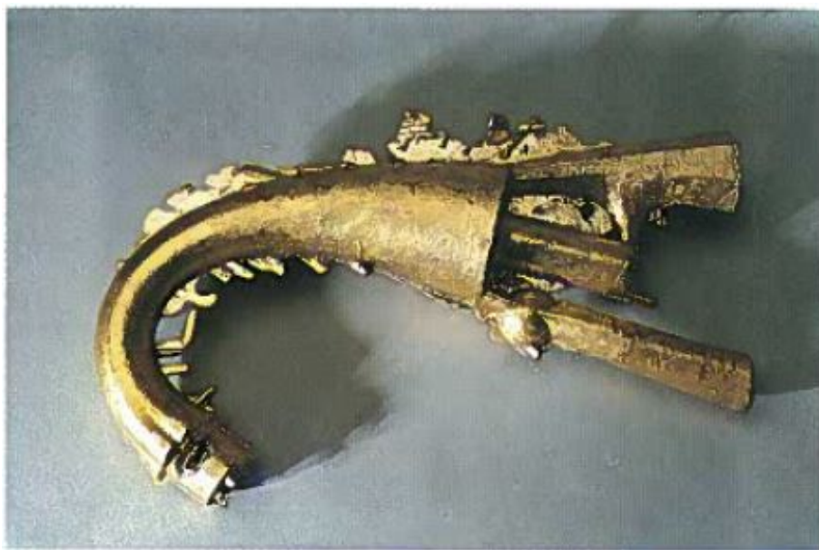
Figura 2.16: Peça com Rebarbas devido a empeno da coquilha [Fernando Portela de Castro (1996)]
