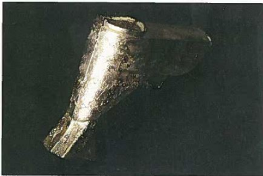
Figura 2.14: Peça com Rugosidade provocada por gitagem incorreta [Fernando Portela de Castro (1996)]
