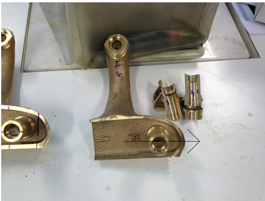
Figura A.2: Cortes na torneira com muitas fugas e com poucas fugas
