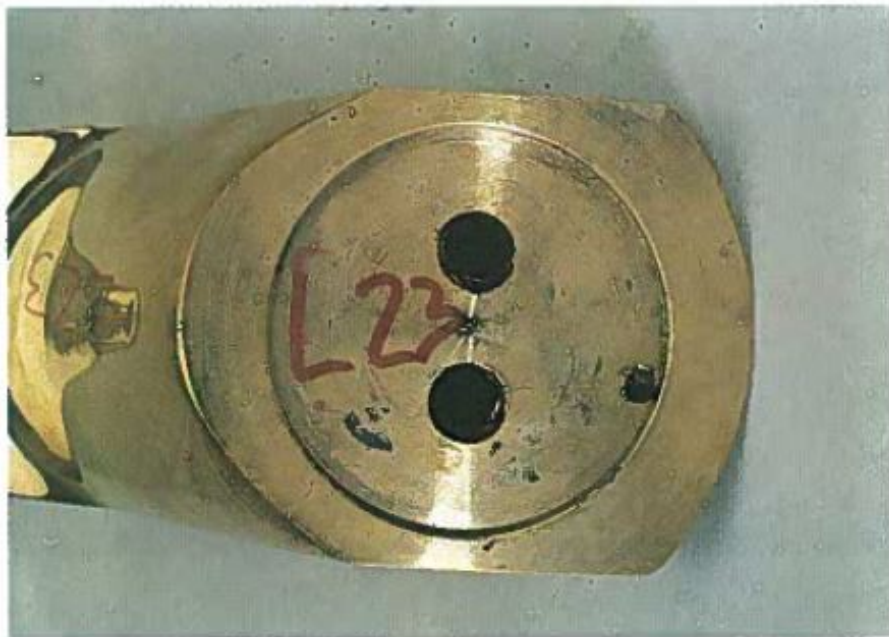
Figura 2.18: Peça com refervido [Fernando Portela de Castro (1996)]
