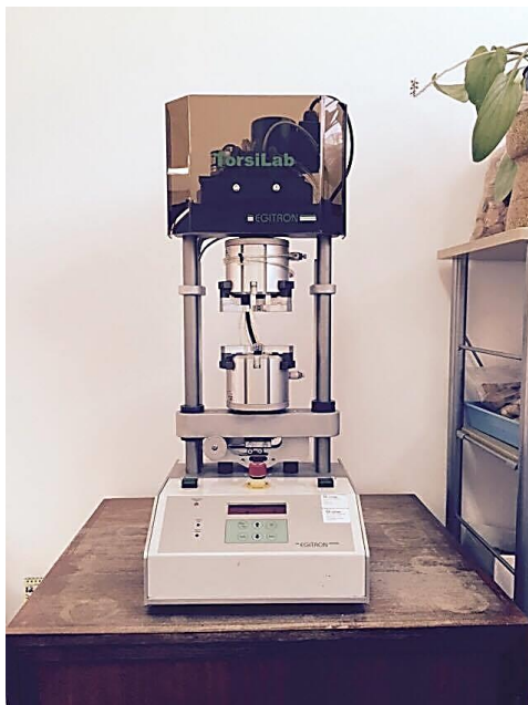
Figura 3.3- Equipamento de medição do ensaio de torção.
