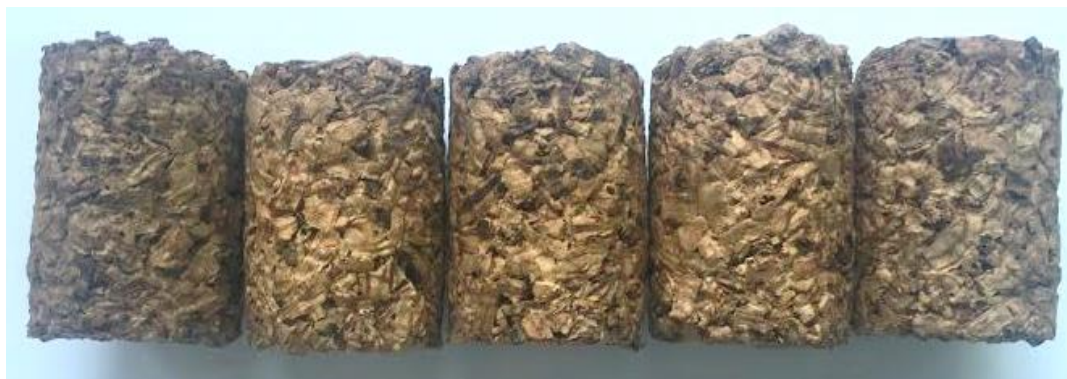
Figura 4.10- Corpos aglomerados após o ensaio de água fervente.
