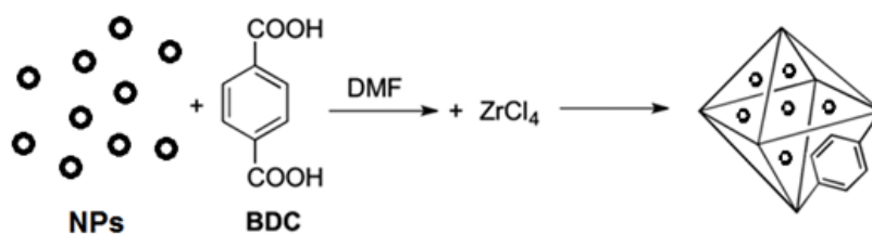
Figura 3.6 – Esquema reacional da impregnação das nanopartículas no MOF UiO-66.
