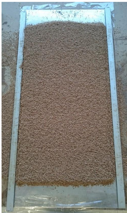
Figura 11 - Molde para produção dos painéis de cortiça
