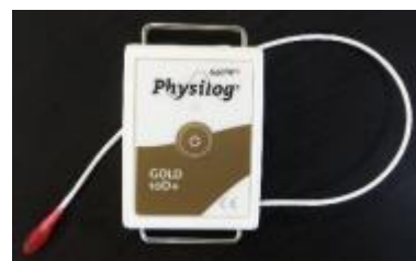
Figura 10 - Módulo Droplet conectado com Physilog 4
