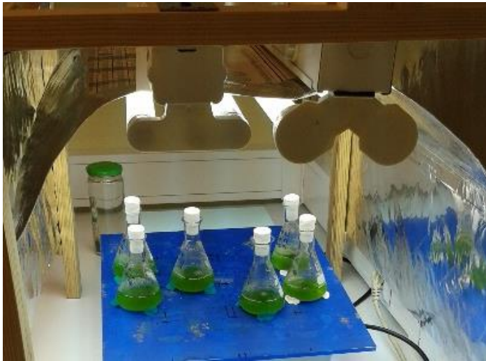
Fig. 8 Imagem ilustrativa da câmara de iluminação de bancada laboratorial construída para ensaios com microalgas. Notar os painéis refletivos laterais amovíveis e o defletor superior para maximização da iluminação.
