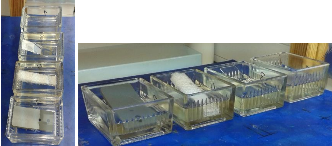
Fig. 11 Ensaio preliminares de adesão. Da esquerda para a direita: PVC (1), Espuma de Poliuretano (2) e Vidro (3). O recipiente 4, ao fundo, é o controlo sem substrato.
