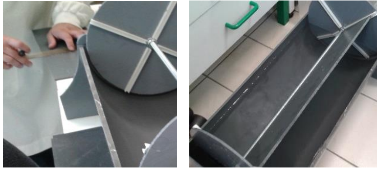
Fig. 16 Construção do protótipo de Bioreator de Biofilme Microalgal em Placas e ensaios de estanquicidade e robustez.
