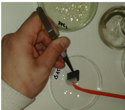
Fig. 13 Obtenção de amostras dos ensaios de adesão em coupons para contagem celular.
