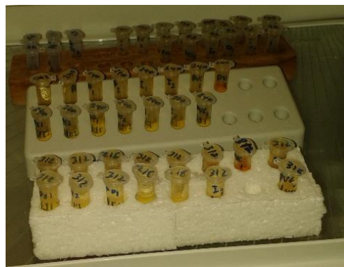
Fig. 13 Obtenção de amostras dos ensaios de adesão em coupons para contagem celular.
