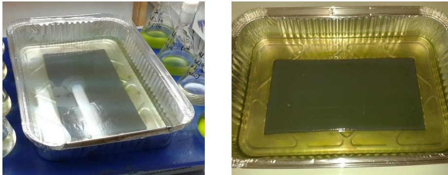
Fig. 34 Aspeto do ensaio preliminar de desenvolvimento de uma cultura de Chlorella vulgaris aderida a uma placa de PVC (à esquerda o início e à direita o fim do ensaio).
