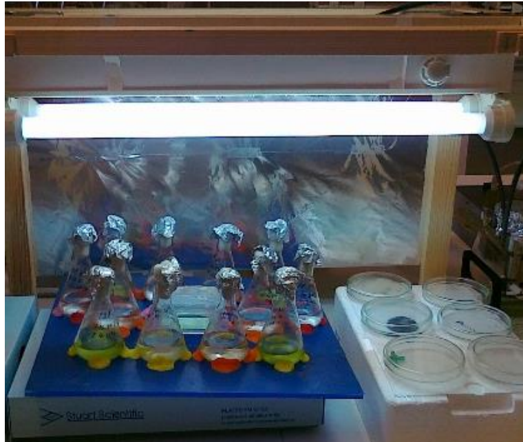
Fig. 10 Montagem para avaliação preliminar da capacidade de adesão de Chlorella vulgaris a diferentes substratos (vidro, centro da plataforma oscilante) e outros materiais (à direita).
