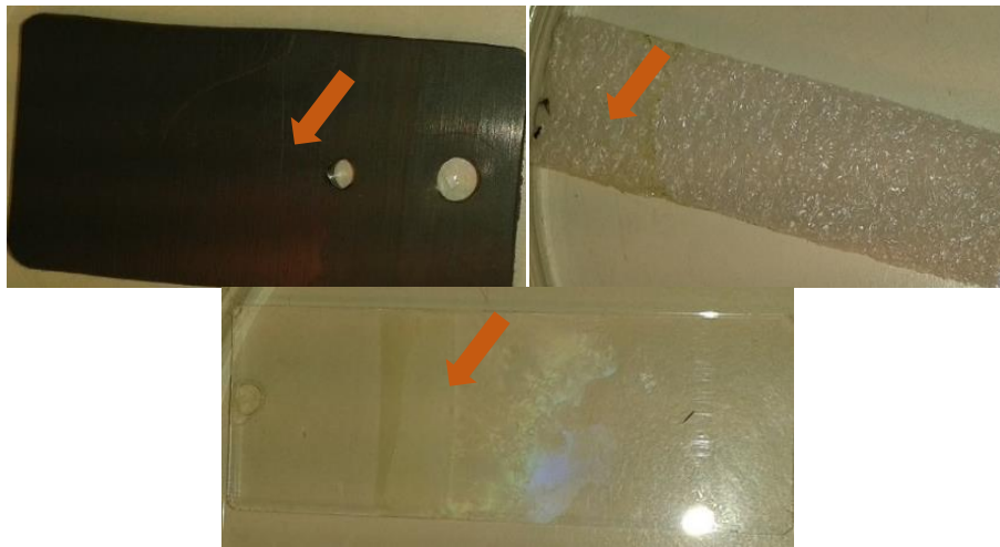
Fig. 27 Exemplos elucidativos da capacidade de adesão de Chlorella vulgaris SAG 211-12 a PVC (cima à esquerda), Poliuretano (cima à direita) e Vidro (em baixo) ( Setas ).
