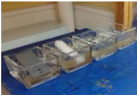
Fig. 26 Avaliação preliminar da adesão de Chlorella vulgaris a PVC, Poliuretano e Vidro, através da evolução da absorvância da suspensão da cultura nas tinas com os diferentes materiais, em função do tempo. Os dados encontram-se apresentados graficamente como a média dos valores obtidos para cada condição experimental.
