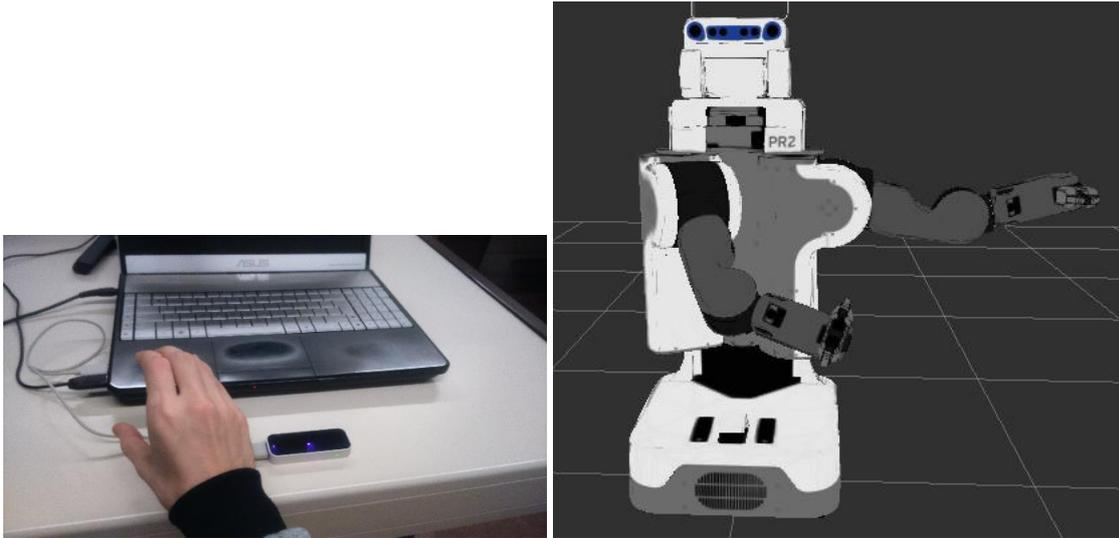
**Figura 19: Controlo do robô - garra para a esquerda e para baixo, a apontar para a frente e aberta quase na vertical.**
