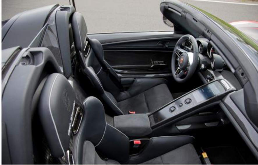
Figura 14. Bancos do Porsche 918 em compósitos (Company, amp, e Porsche Cars North America 2014).
