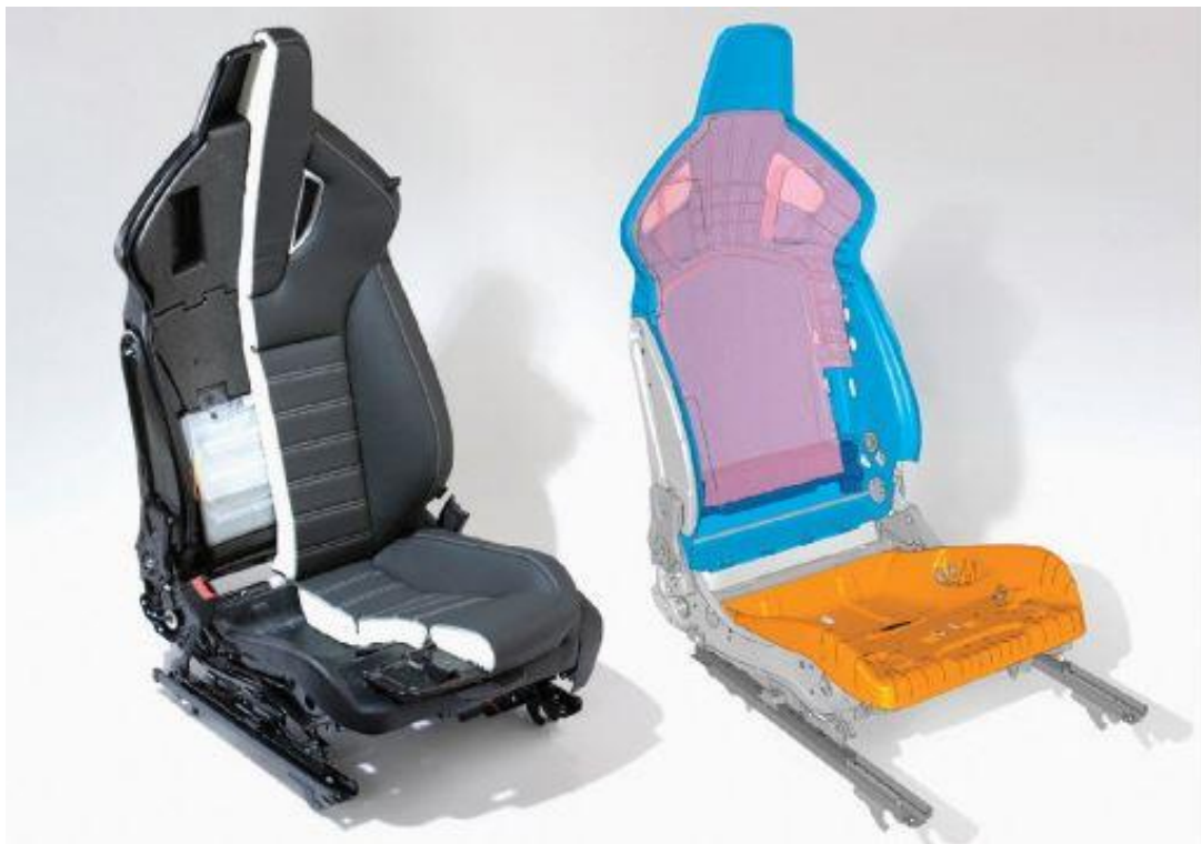
Figura 13. Polímero reforçado com fibra de vidro elimina a necessidade de estrutura de aço (Stewart 2010).
