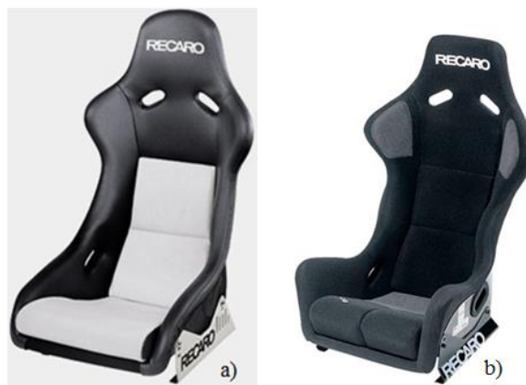
Figura 15. Bancos recaro em polímero reforçados com fibra (Tweeks 2014).
