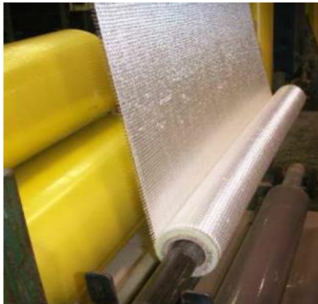
Figura 27. Colocação do rolo corretamente (Berger 2011).
