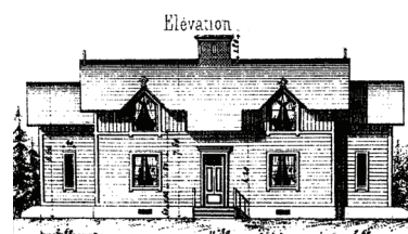
Fig. 48: Estocolmo: alçado das casas quadripartidas para a Ekman, construídas em madeira.
