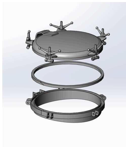
Figura 29 - Entrada de homem superior (vista explodida)
