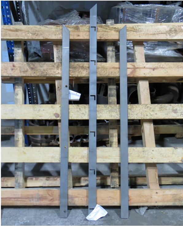
Figura 68 - Três das barras laterais da escada
