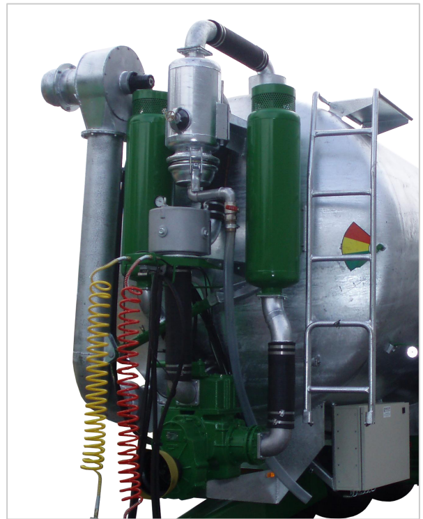
Figura 6 - Silenciador e válvula secundária
