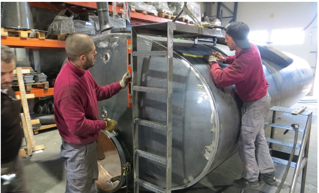
Figura 70 - Montagem da escada na cuba
