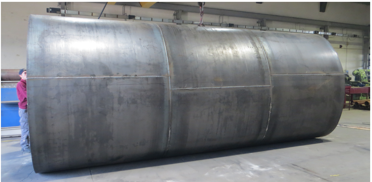
Figura 47 - As três virolas soldadas (vista inferior)
