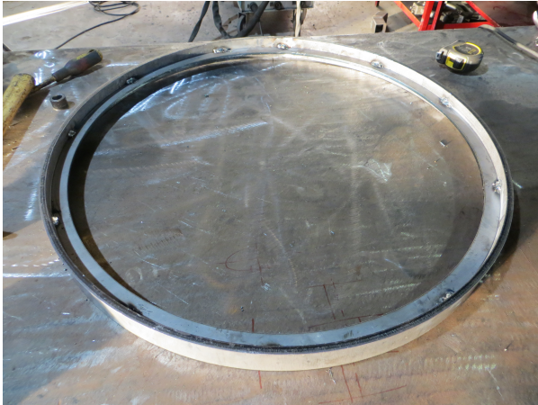
Figura 54 - Corpo da entrada de homem superior
