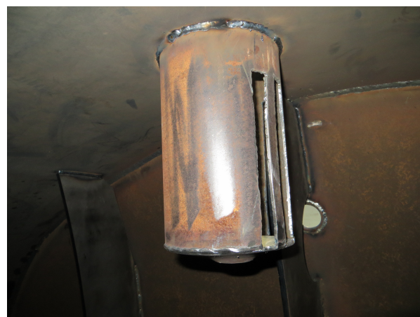
Figura 74 - Picagem para montagem da válvula primária
