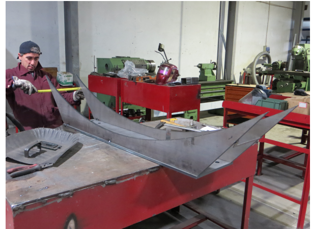
Figura 66 - Alinhamento das chapas verticais do berço
