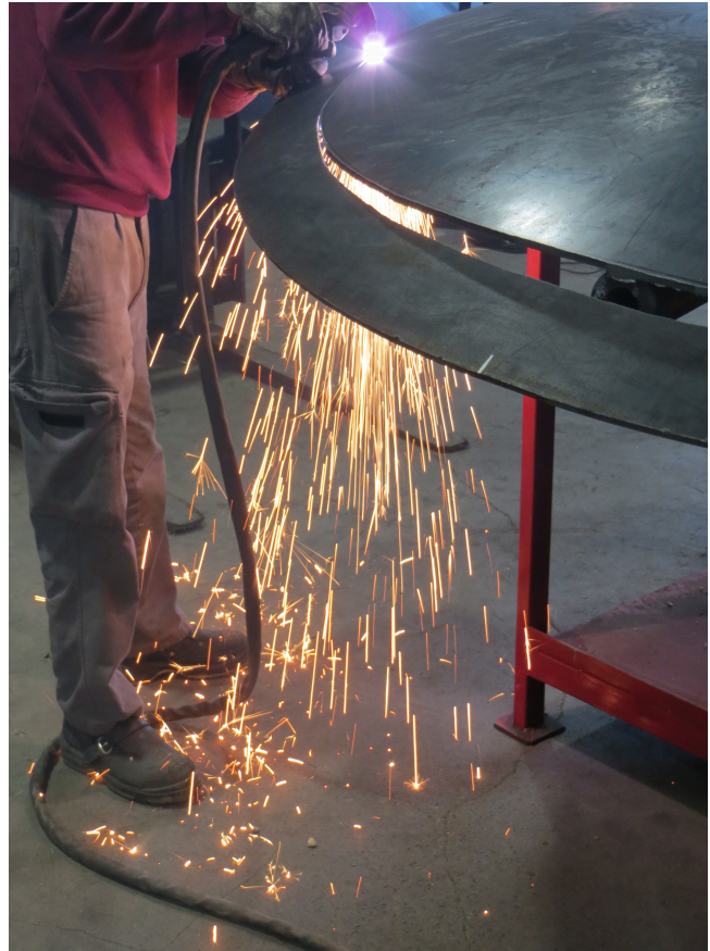
Figura 53 - Desperdício de chapa do fundo copado
