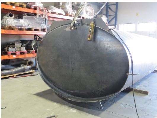
Figura 52 - Fundo copado, depois de cortado
