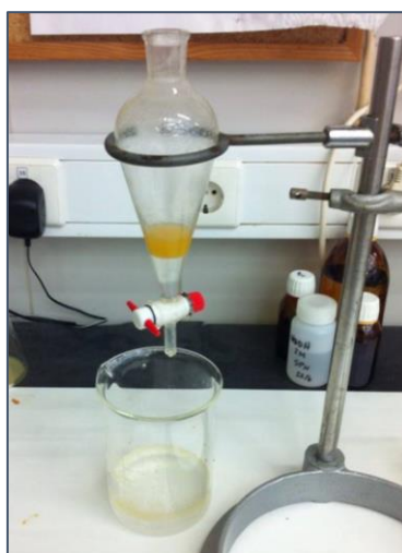
Figura 3.7. Montagem experimental relativa à separação por decantação.
