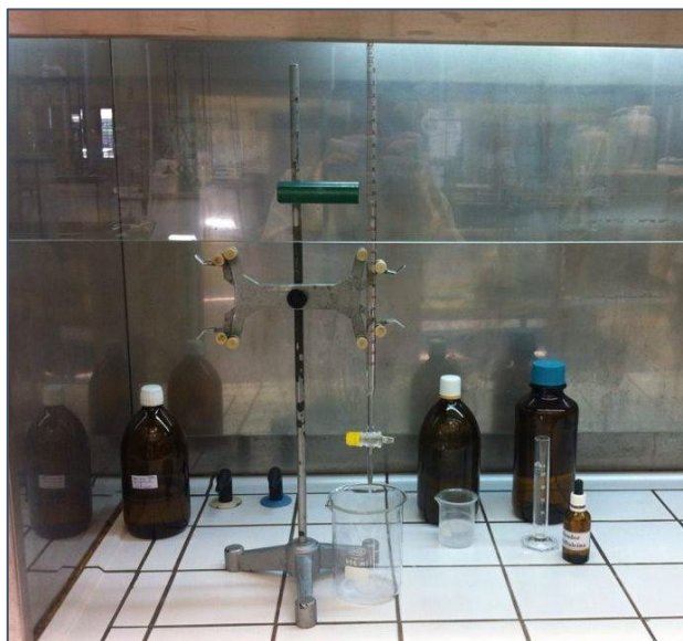
Figura 3.8. Montagem experimental relativa à medição do índice de acidez.
