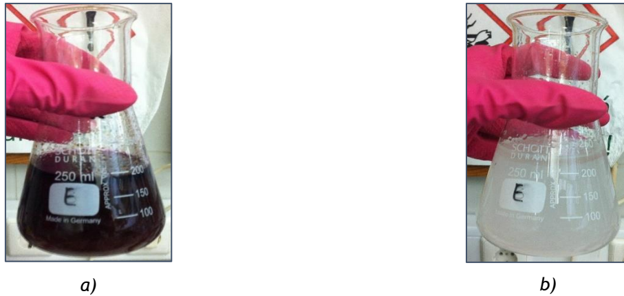
Figura 3.2. Mistura antes e após a titulação para determinação do índice de iodo.
