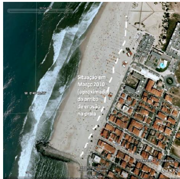
Figura 4.5 - Praia a norte do esporão norte do Furadouro em 2006 e em Março de 2010 (indicação aproximada da arriba de erosão) (Veloso-Gomes, 2010).
