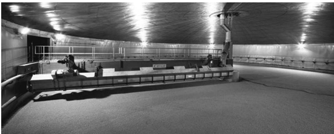
Figura 16. Tanque de estufagem single deck circular [de Pinho Ferreira Guiné e dos Reis Correia, 2013].
