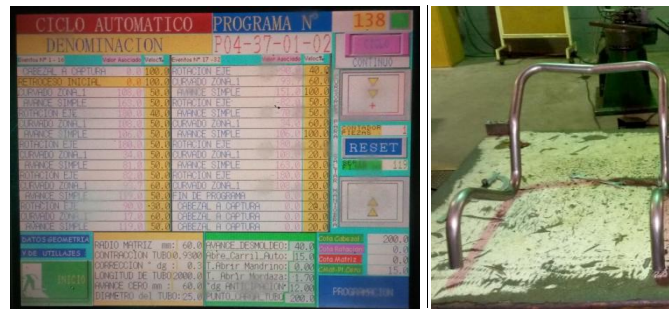
FIGURA 111: ESTRUTURA DE SUPORTE DO ASSENTO FINALIZADA.
