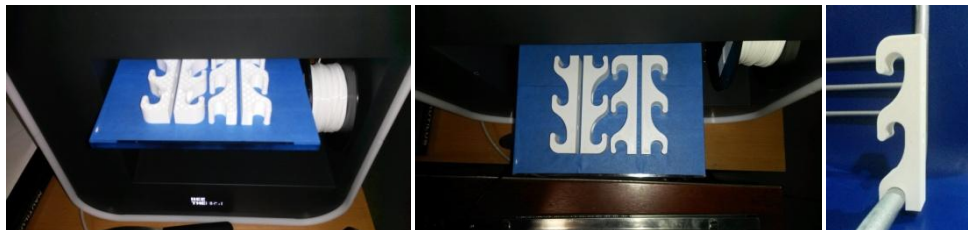
FIGURA 137: IMPRESSÃO 3D PEÇAS DE REGULAÇÃO.
