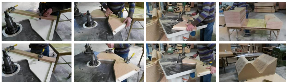
FIGURA 121: A) FIXAÇÃO DOS GRAMPOS AO MOLDE; B) FIXAÇÃO DAS PLACAS AO MOLDE; C) UNIFORMIZAÇÃO DAS PLACAS; D) PLACAS FINALIZADAS.
