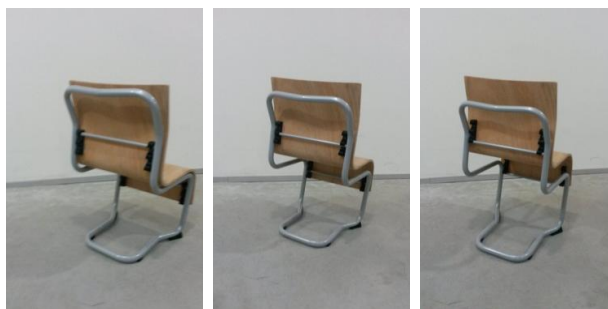
FIGURA 150: REGULAÇÃO NOS TRÊS NÍVEIS – ENSAIO 1.
