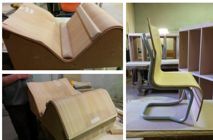
FIGURA 133: RESULTADO DA TERCEIRA PRENSAGEM.
