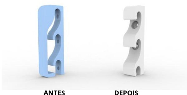
FIGURA 99: PEÇA DE REGULAÇÃO ANTES E DEPOIS DAS ALTERAÇÕES PROPOSTAS PELA EMPRESA.
