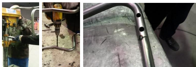
FIGURA 113: FURAÇÃO PARA POSICIONAMENTO DAS TRAVESSAS.
