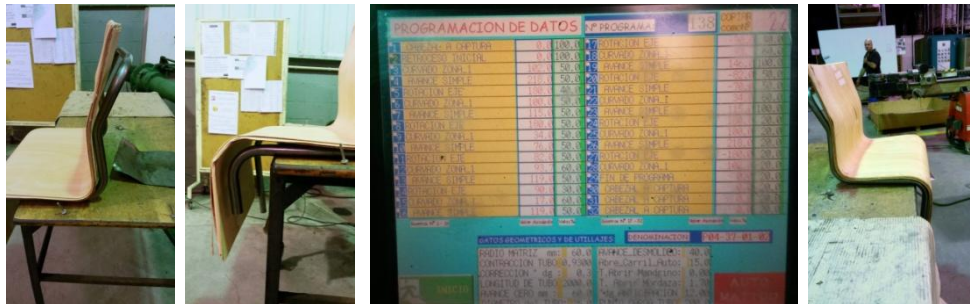
A) FIGURA 139: A) ENSAIOS SUPORTE DO ASSENTO FALHADOS; B) PROGRAMA E SUPORTE DO ASSENTO FINAL.
