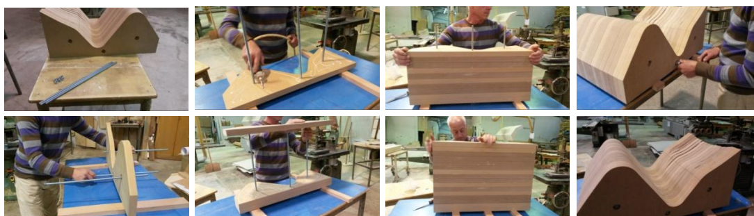
FIGURA 124: MONTAGEM FINAL DO MOLDE.
