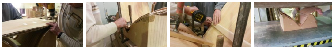
FIGURA 132: PREPARAÇÃO DA TERCEIRA PRENSAGEM.
