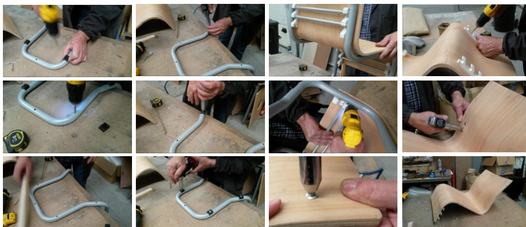
FIGURA 140: APLICAÇÃO DAS MEIAS CANAS E FIXAÇÃO PEÇAS DE REGULAÇÃO.
