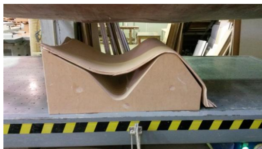
FIGURA 129: RESULTADO DA PRIMEIRA PRENSAGEM.
