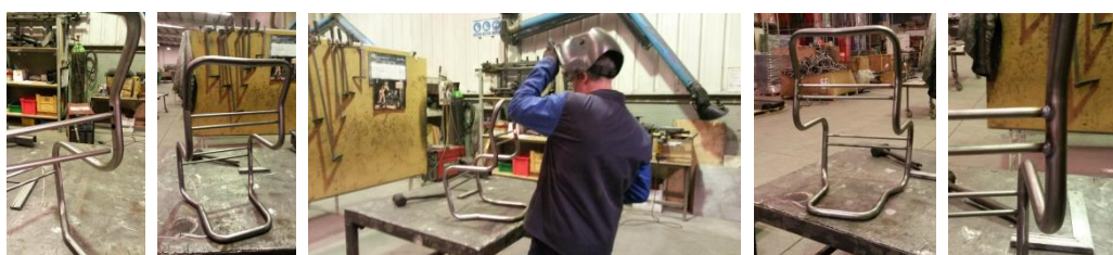
FIGURA 114: SOLDADURA DAS TRAVESSAS.
