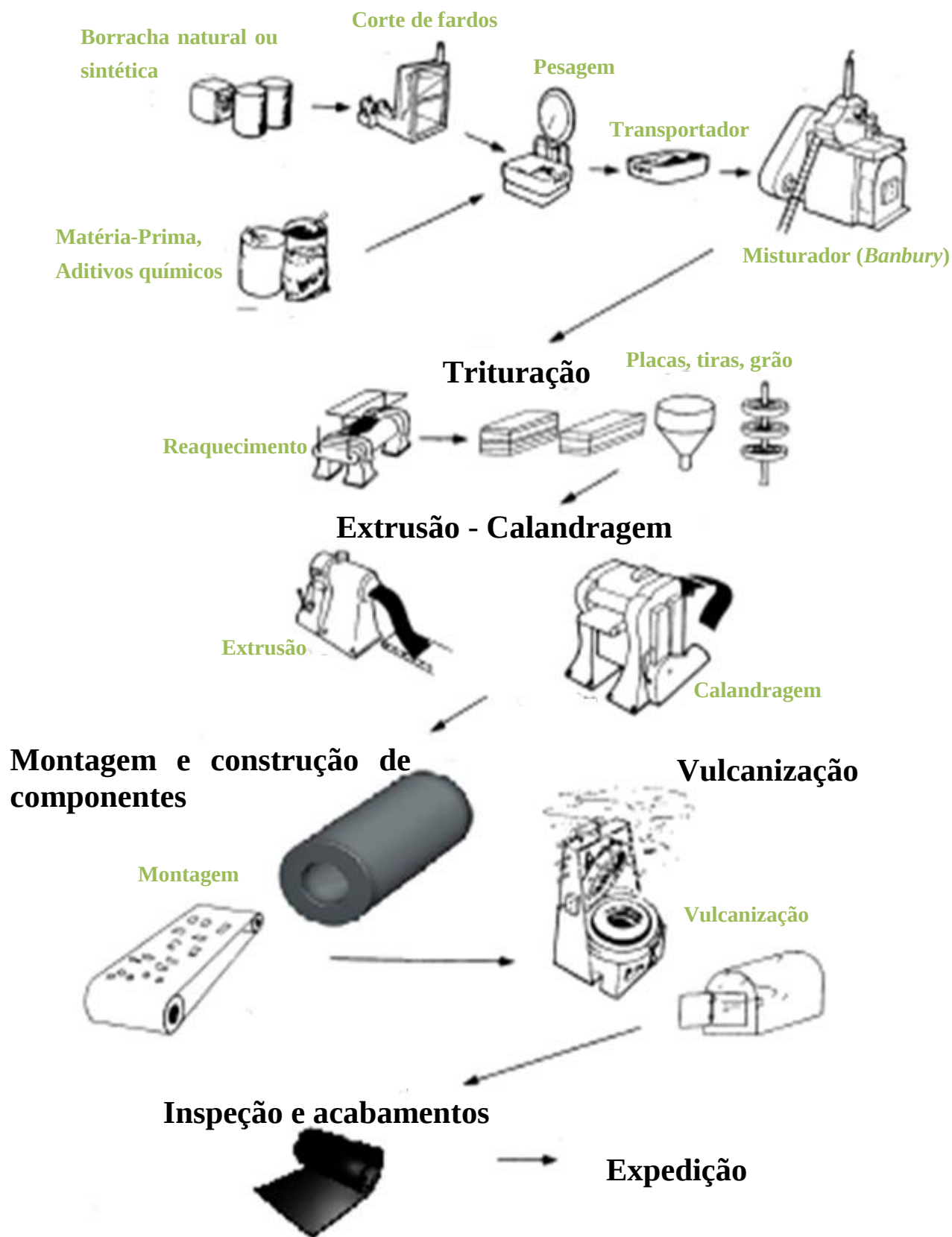
Figura 1 - Diagrama do processo produtivo de uma indústria de produtos de borracha.
