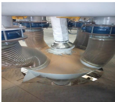
Figura 34 - Manga filtrante implementada no pião de granulado
