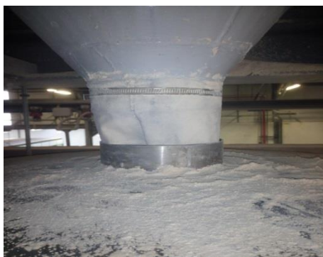
Figura 18 - Descarga do caulino pião-balança
