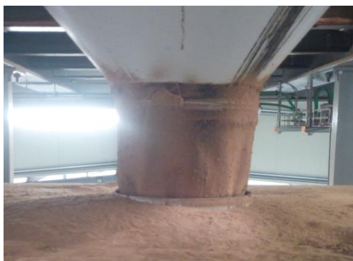
Figura 9 - Manga de tecido que une o pião à balança
