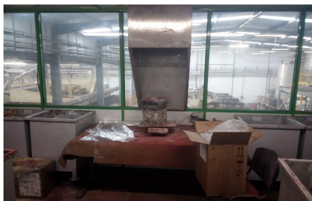
Figura 23 - Cabine de pesagem manual dos químicos
