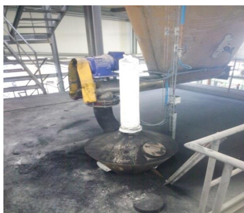
Figura 33 - Manga filtrante implementada no pião do negro de fumo
