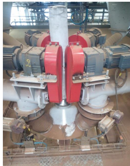
Figura 26 - Manga filtrante implementada no pião
