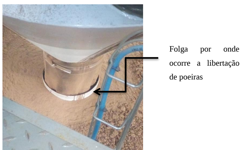
Figura 28 - Manga de encaminhamento do granulado do pião para a balança
