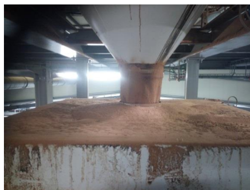
Figura 6 - Descarga de granulado do pião para a balança (Piso 3)
